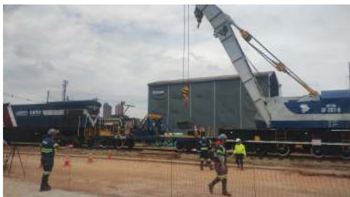
◆ Guindaste Orton da Rumo utilizado no simulado tracionado por locomotiva da ABPF.
