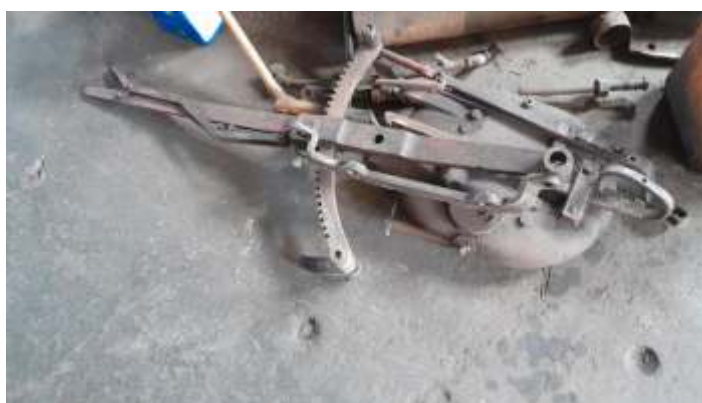
◆ Alavanca do regulador e porta da fornalha já limpos.
