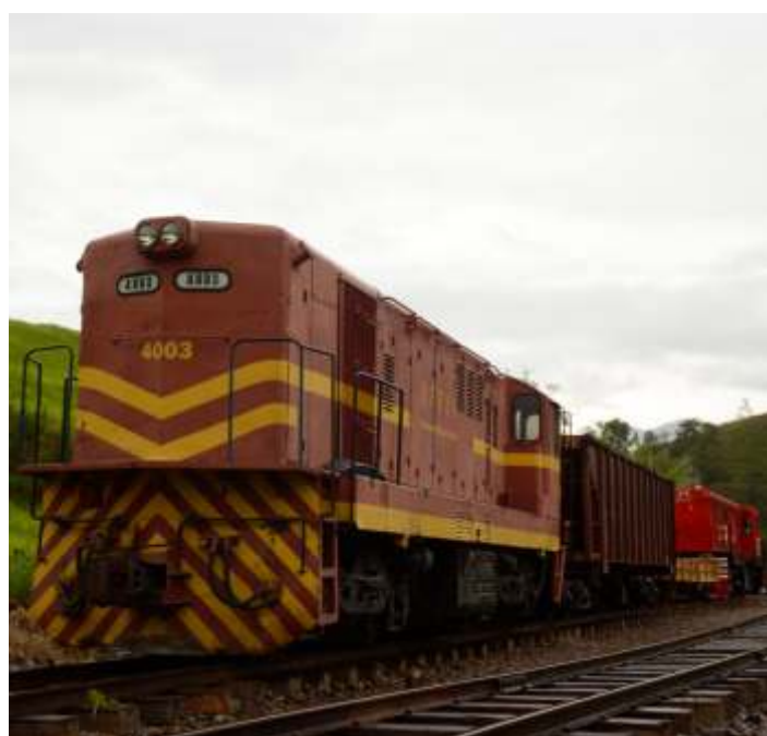
♦ O trem de lastro nas imediações da estação Rufino de Almeida. Já foram feitas dezenas de viagens para aplicação do lastro novo ao longo do trecho recuperado.
