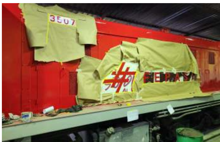
♦ Aplicação das máscaras para pintura.
