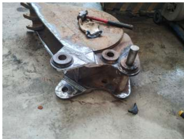
◆ Detalhes da recuperação da concha traseira. Foto HGF.
