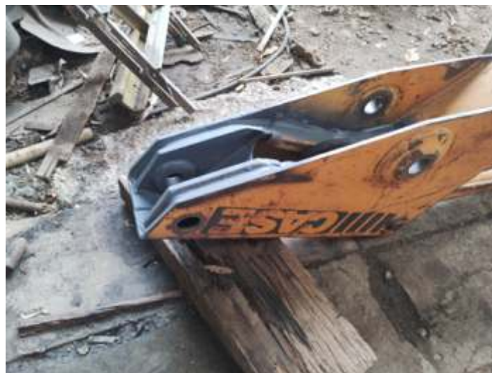
◆ Detalhe da Reforma da Retroescavadeira Case 580 H. Foto HGF.
