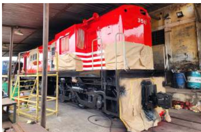
♦ Empapelamento e aplicação da cor preta.
