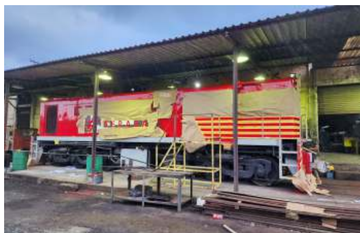
♦ Máscaras para pintura e empapelamento prontos.
