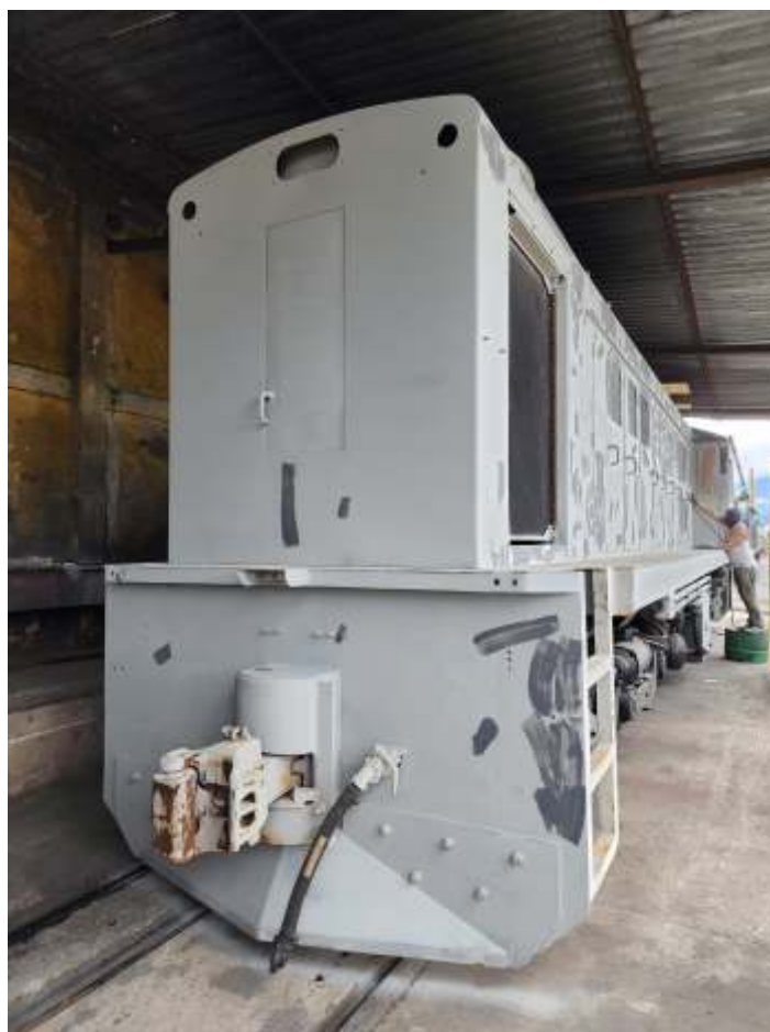
◆ Preparação final da ALCO RSD8 para receber a pintura.
