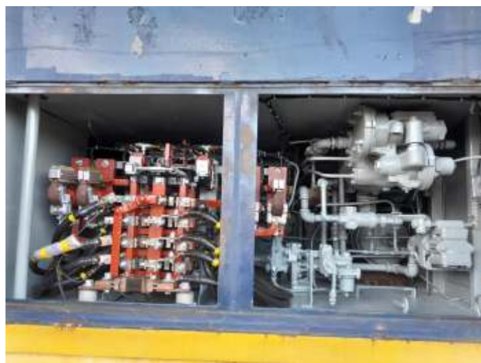
♦ Seguem os trabalhos na GE 80Ton; no momento, toda a parte elétrica está sendo revisada e refeita.
