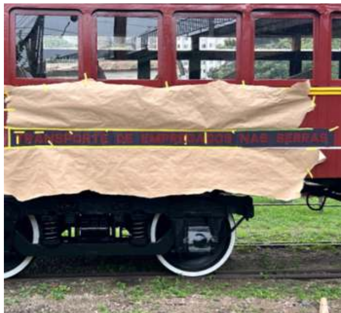
♦ As máscaras já aplicadas aguardando a pintura amarela.
