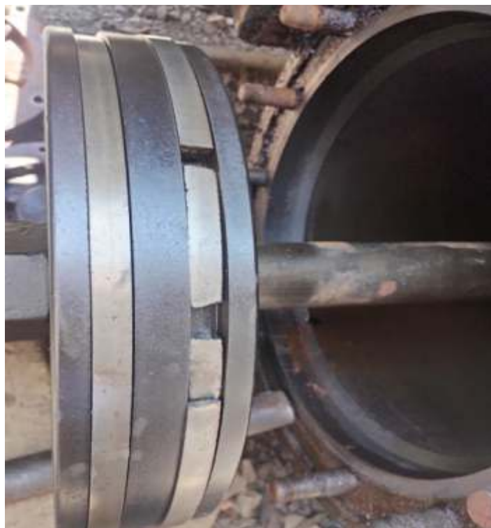
◆ Detalhe dos anéis de um dos pistões da loc. 9 quebrado. Foto HGF.
