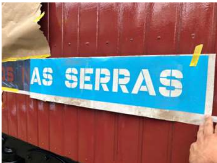
♦ Aplicação das máscaras de pintura do novo Layout.
