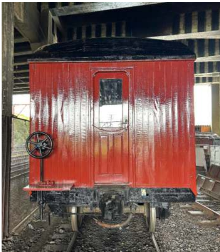
♦ O carro já com a nova pintura do tipo PU e com aplicação de verniz.
