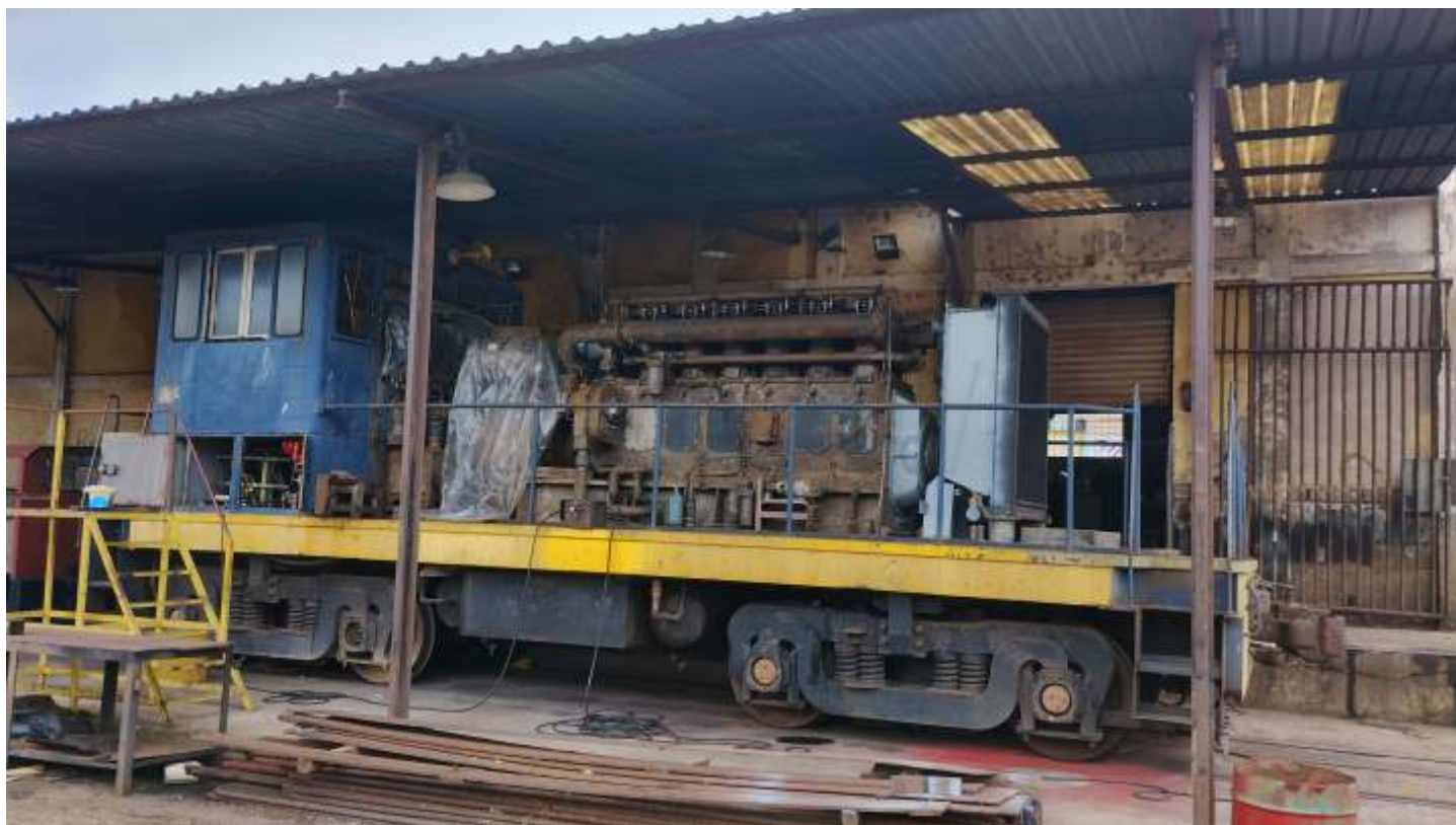
♦ Seguem os trabalhos na GE 80Ton; no momento, toda a parte elétrica está sendo revisada e refeita.
