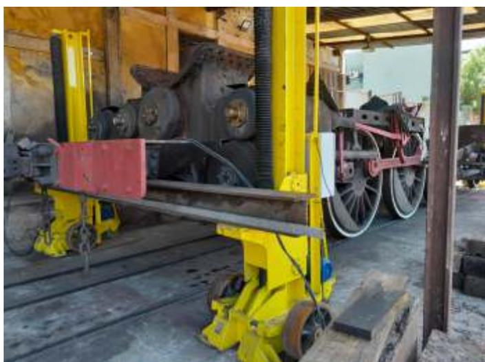
◆ Início do processo de levantamento da locomotiva para remoção dos rodeiros motrizes.
