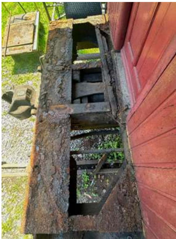
♦ Detalhes do piso das cabeceiras do #1032, após retirada da placa metálica que o reveste.
