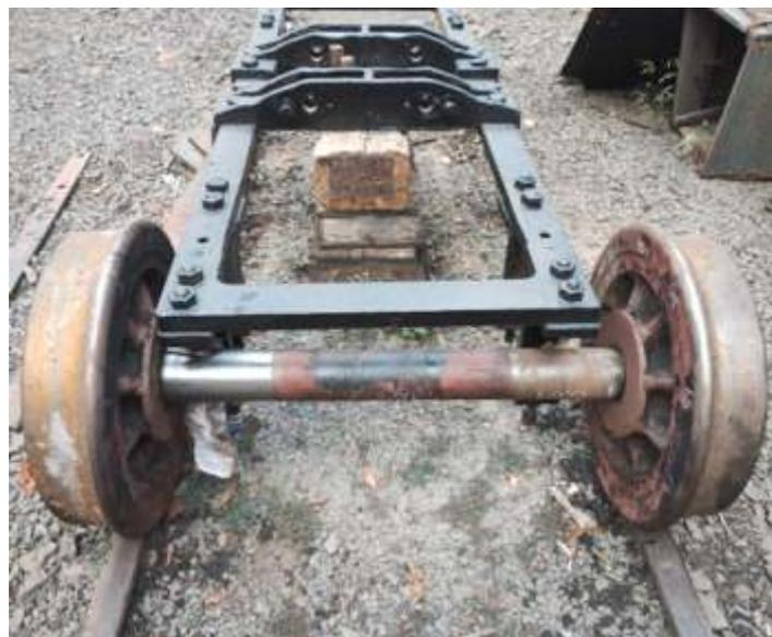
♦ Rodeiro recebido após reperfilamento, sendo preparado para montagem. Foto HGF.
