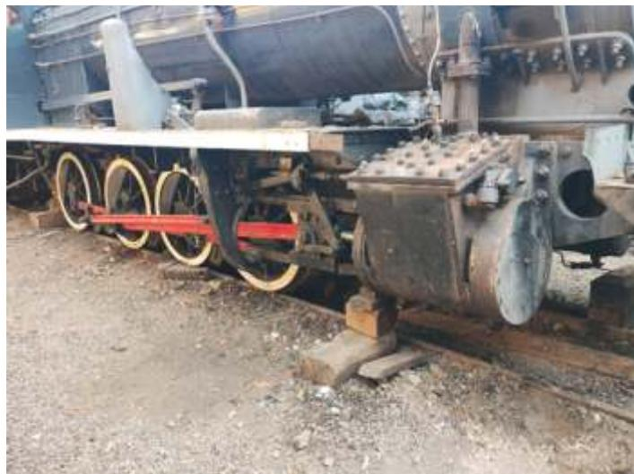
♦ Lado maquinista já montado aguardando testes e colocação do trole. Foto HGF.
