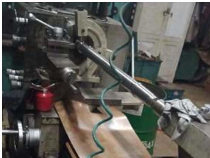
♦ Nova haste em processo de usinagem.
