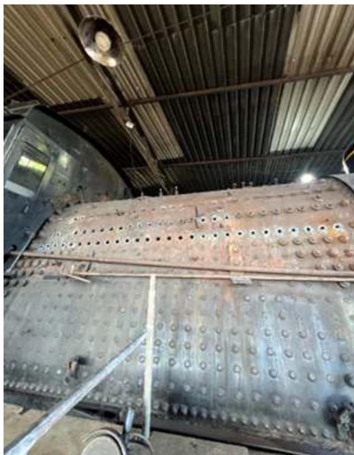
♦ Limpeza da chaparia da fornalha para a instalação dos novos estaes.
