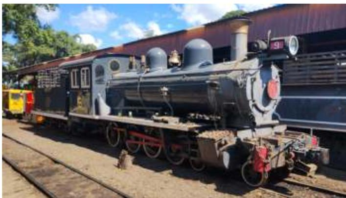
♦ Locomotiva 9 já com rodas montadas e preparada para testes. Foto HGF.
