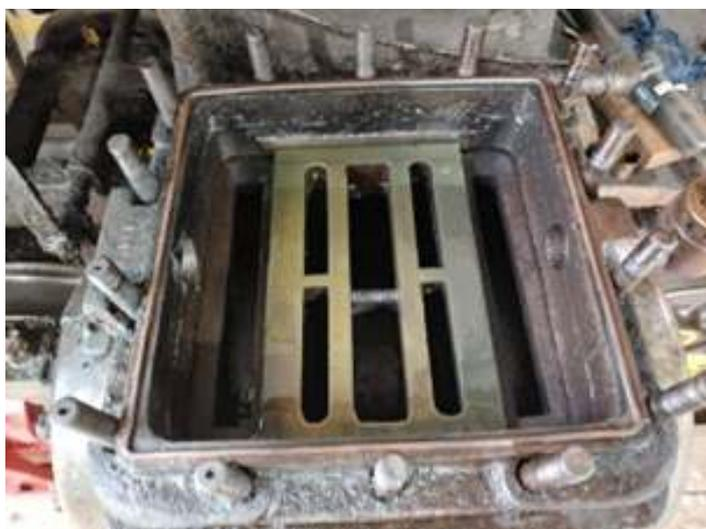
◆ Etapa de inspeção da gaveta da locomotiva durante a remoção da válvula de distribuição.
