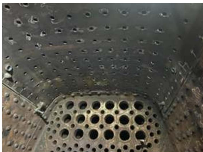
♦ Vista da parte posterior e frontal da fornalha da locomotiva com a nova chapa já instalada.
