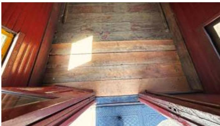
◆ Após a instalação das novas placas de madeira, o piso foi totalmente lixado para receber, em breve, aplicação de verniz brilhante em todo o piso do carro 1032.
