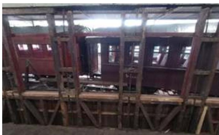
♦ Remoção do revestimento externo e interno, evidenciando o esqueleto do veículo.
