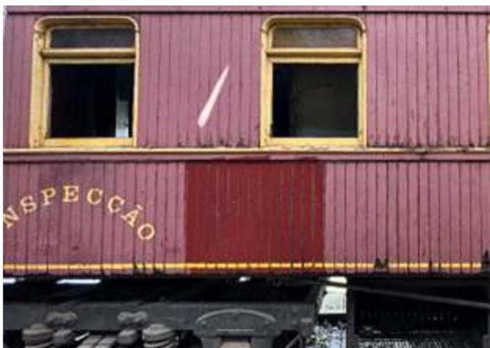
◆ Um “antes e depois” na lateral do carro com a aplicação do óleo mineral USP, notando se bem a diferença que o produto proporciona ao madeiramento.
