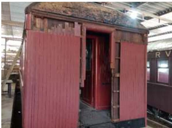
◆ Etapa de remoção do madeiramento comprometido nas colunas.
