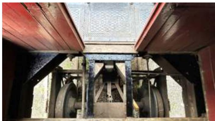
♦ Detalhes das cabeceiras após retirada do madeiramento antigo.
