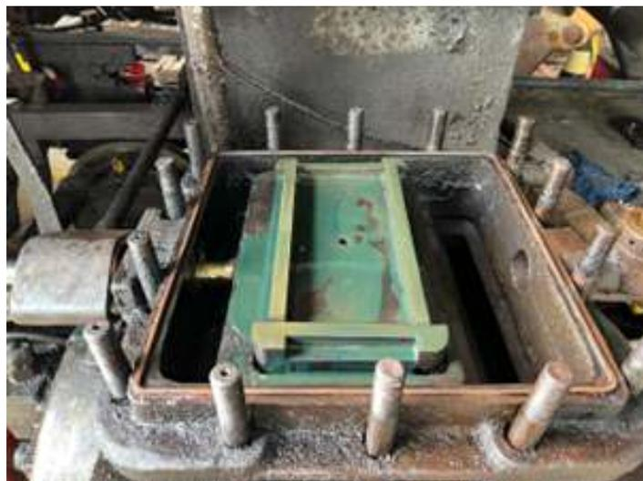
◆ Gaveta da válvula de distribuição já instalada juntamente com a nova haste.
