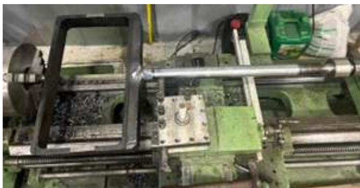
◆ Etapa de usinagem da nova haste da válvula de distribuição.
