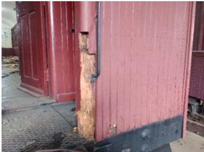
◆ Vista do madeiramento comprometido e preparado para retirada.
