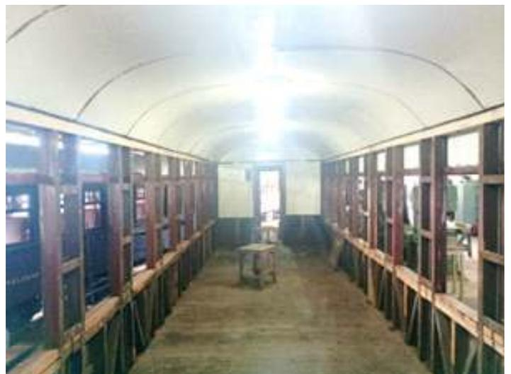
◆ Vista geral do interior do veículo evidenciando as duas novas vigas superiores.
