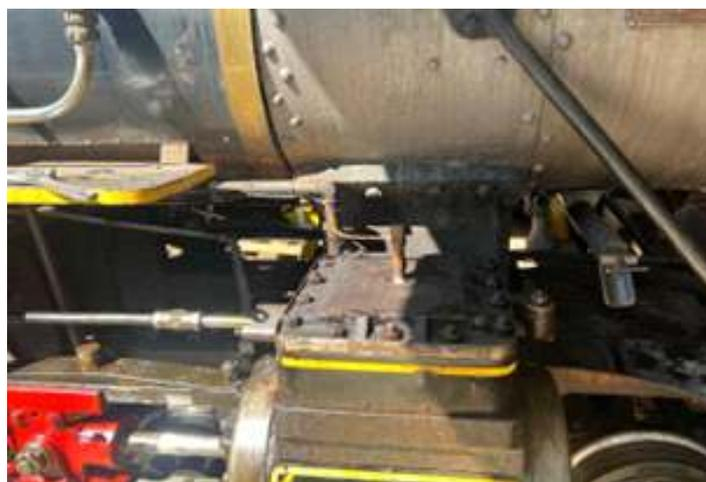
◆ Válvula de gaveta já fechada e selada estando a locomotiva, pronta para voltar à operação.
