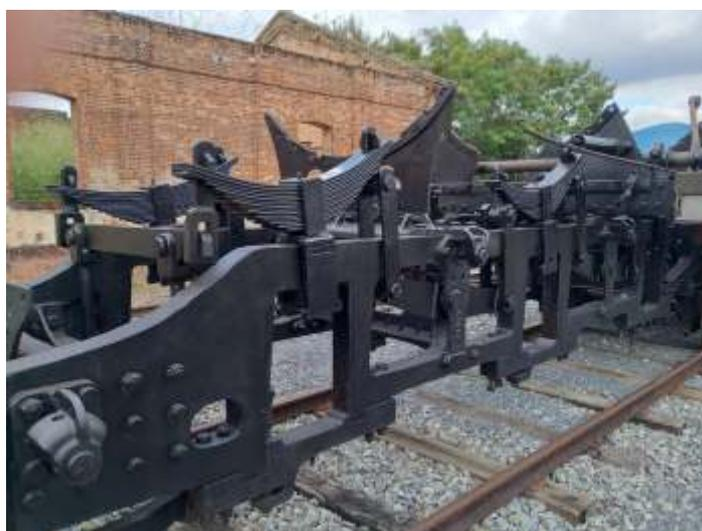
♦ Aspecto do longirão já pintado e com praticamente todo o sistema de suspensão remontado após revisão.
