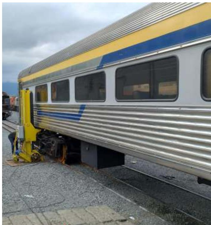
♦ Processo de reinstalação do truque no carro após ser feita a substituição dos rodeiros.
