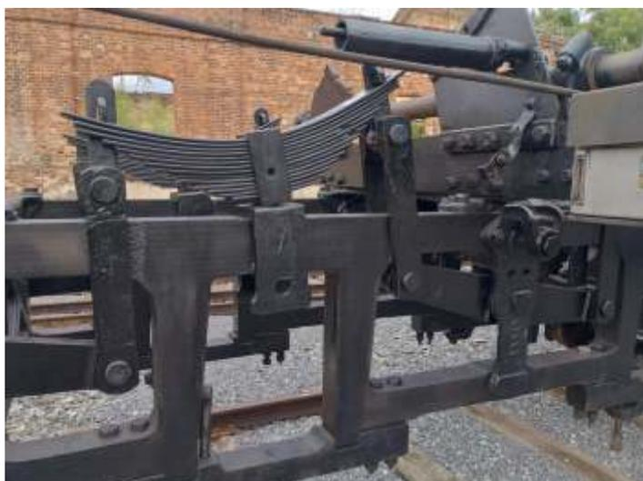
♦ Detalhe do sistema de suspensão já remontado.
