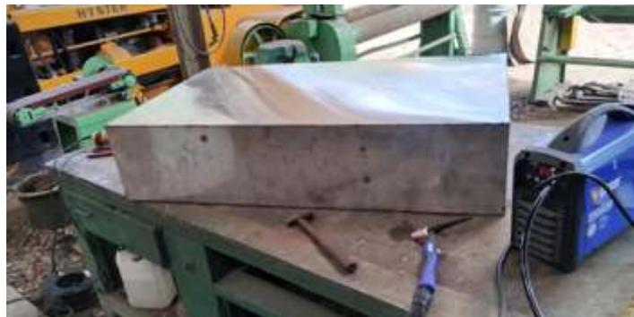
♦ Nova caixa de água sendo fabricada em nossas oficinas. Foto ABPF.
