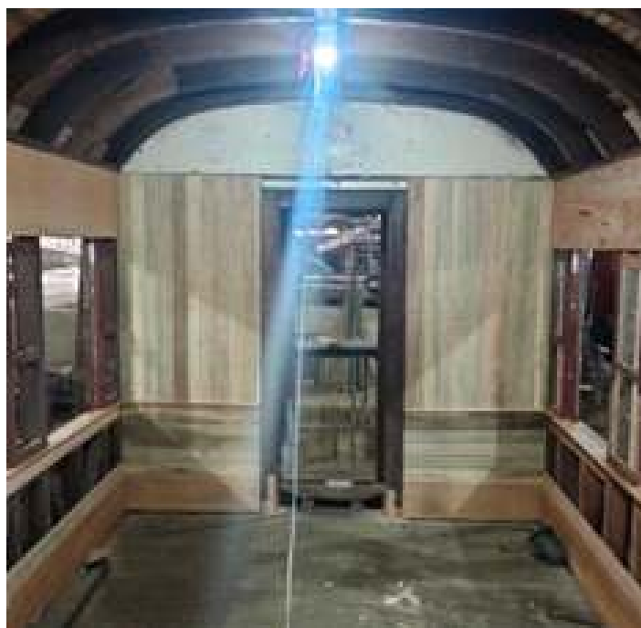
♦ Sequência de imagens apresentando a etapa de instalação de madeiramento interior.
