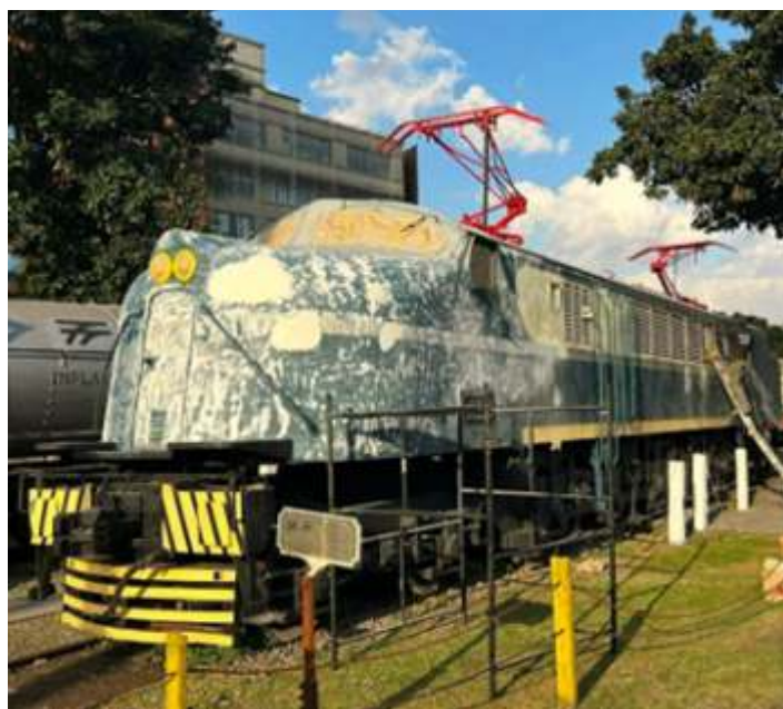
♦ Aplicação de massa poliéster para correção de imperfeições na locomotiva.
