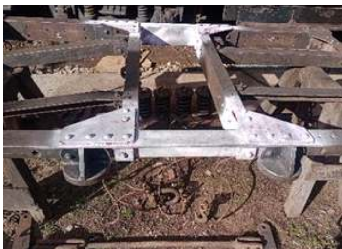
♦ Armação dos truques que irão para o carro PD-64 após inspeção com líquido penetrante em áreas críticas.
