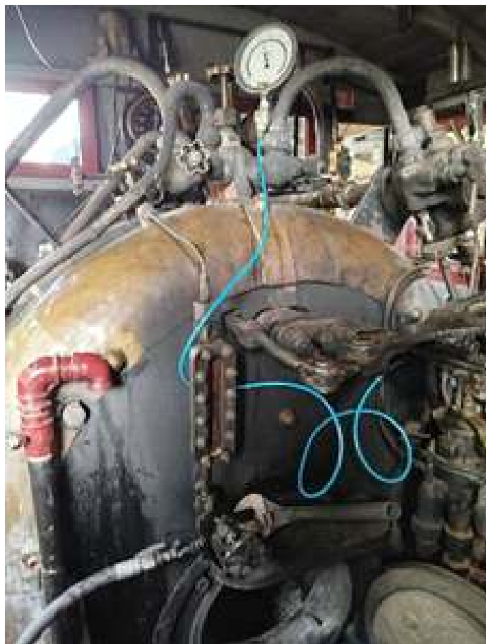
♦ Teste hidrostático da caldeira da locomotiva Ten-Wheel nº. 311.
