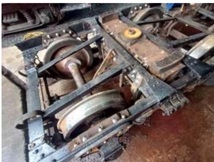
♦ Truques revisados e prontos para instalação no carro de passageiros PM-34.
