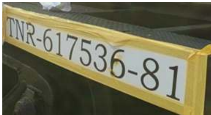
♦ Aplicação das máscaras para pintura no vagão tanque.
