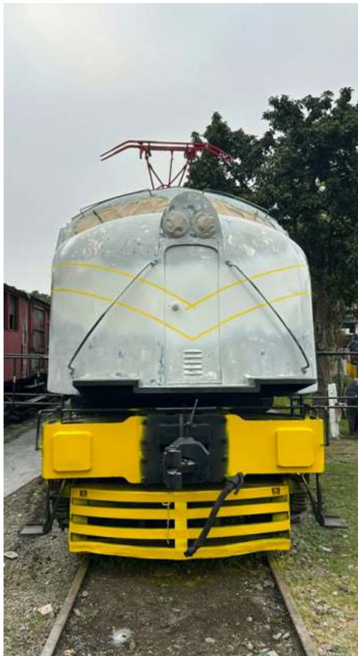
♦ Aplicação do cinza sob o prime e delineação da máscara pra a faixa em ângulo no nariz, e “saindo” para a lateral da locomotiva. Foto: Alexandre A. Pisciotano.
