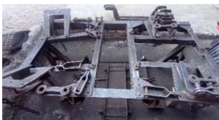
♦ Truques para o carro PD-64, oriundos de Piratuba, já em processo de desmontagem.
