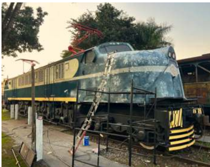
♦ A #6371 já no início do processo de lixamento de toda a superfície da locomotiva, isso permite que o prime aplicado tenha melhor adesão a superfície, incluso o teto que também foi pintado.
