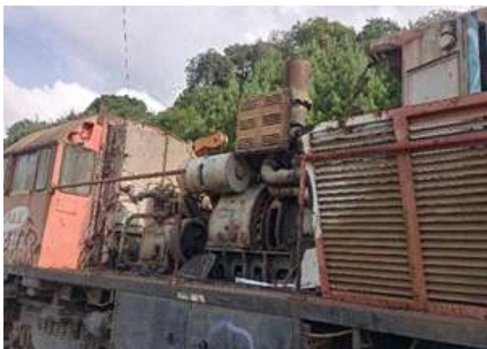
♦ Etapa de desmontagem da carcaça e remoção do motor existente na locomotiva GE U5B nº 2084.
