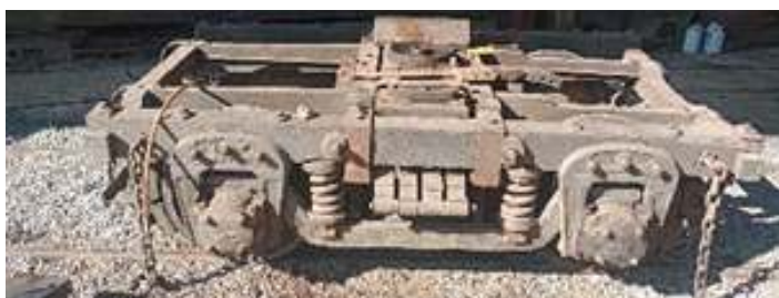
♦ Truque do carro PD-47 já removido, irá para o carro AM-03.
