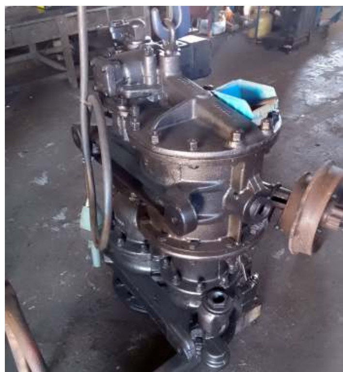
♦ Compressor de ar duplo a vapor recuperado nas oficinas.
