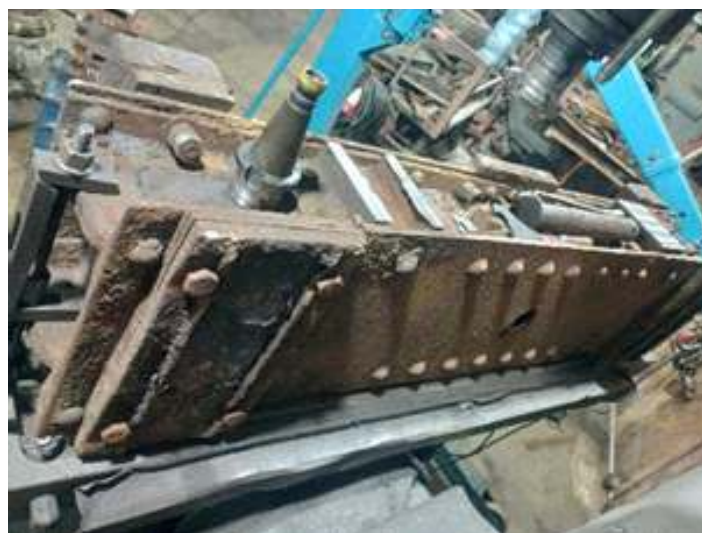
♦ Processo de usinagem dos apoios laterais das mesas.
