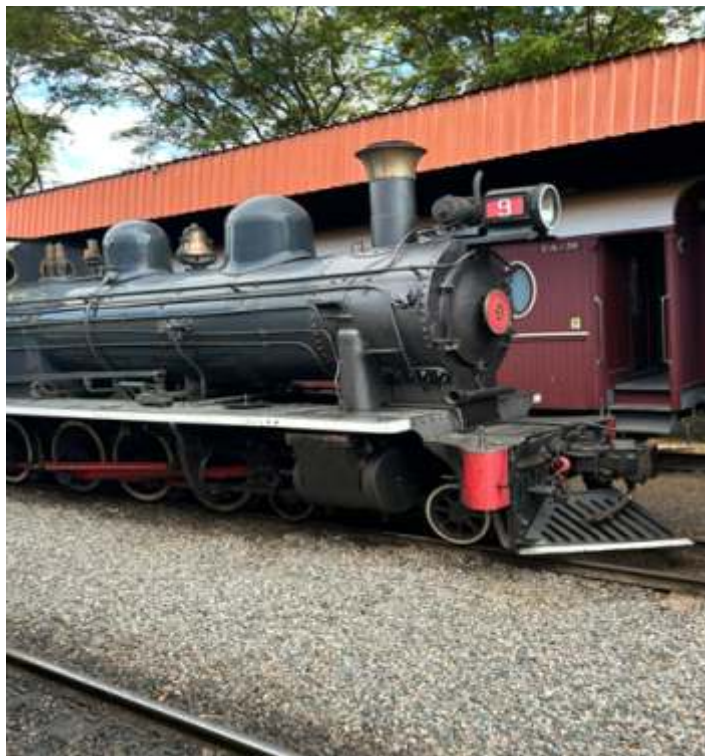
♦ Detalhe da caixa de fumaça aplicado o material de proteção. Foto de Pedro Etter.
