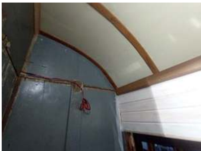
♦ Chaparia do teto do carro com mata-juntas em verniz já instalados.
