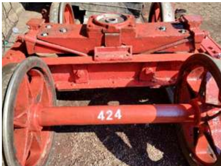
♦ Truque do tender da locomotiva já revisado e pintado, nota-se a marcação do número do eixo, procedimento que será aplicado em todo material rodante desta regional.
