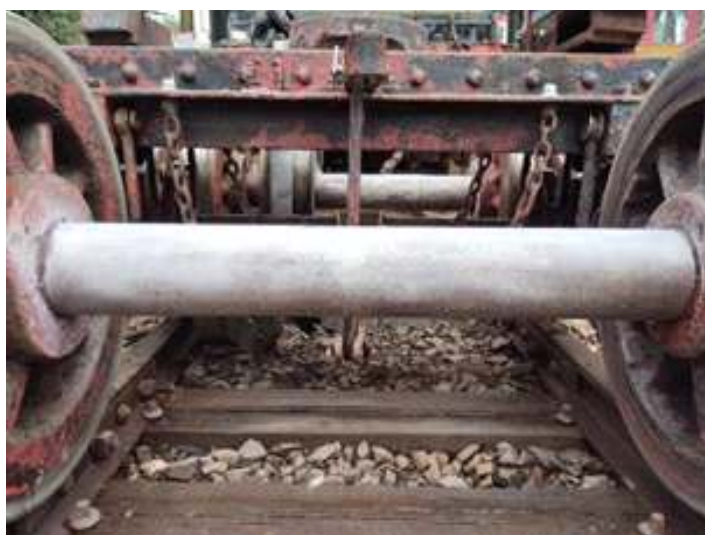
♦ Ensaio com líquido penetrante nos eixos do truque do tender.
