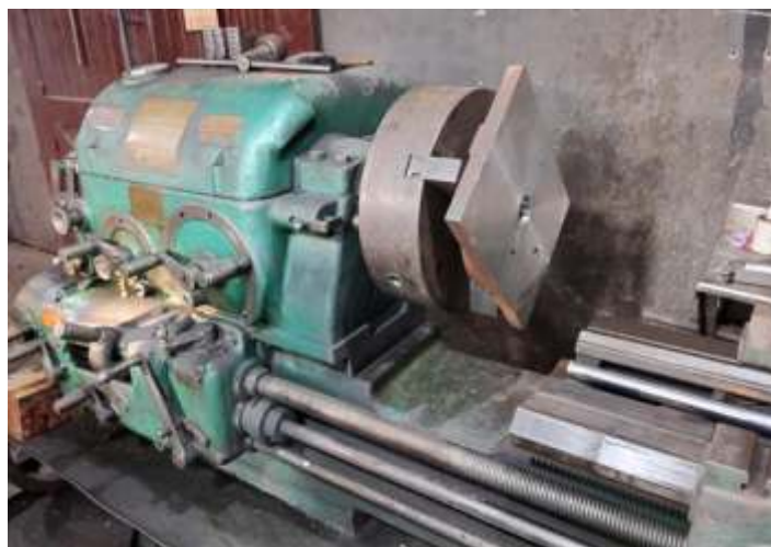
♦ Torneamento das novas placas de centro . Foto HGF.
