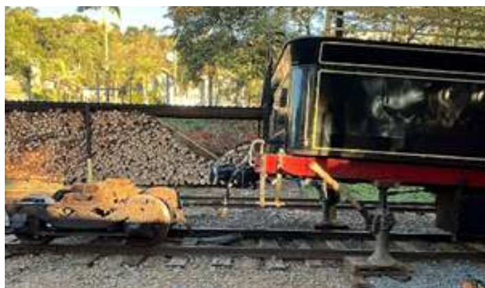
♦ Etapa de remoção dos truques do tender da locomotiva.
