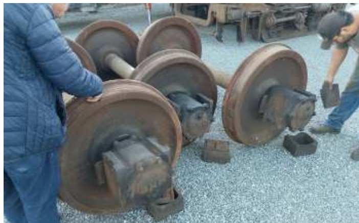
♦ Desmontagem de truques para remoção dos rodeiros.
