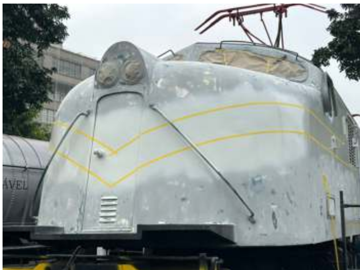
♦ Aplicação do cinza sob o prime e delineação da máscara pra a faixa em ângulo no nariz, e “saindo” para a lateral da locomotiva. Foto: Alexandre A. Pisciotano.
