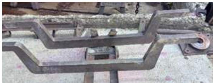
♦ Novas barras de carga cortadas em plasma.
