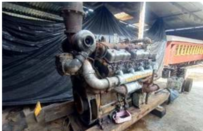
♦ O mesmo motor após retirada do caminhão, já lavado, aguarda sua instalação na locomotiva.
