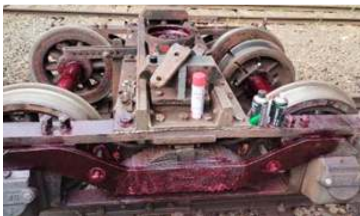
♦ Ensaio por líquido penetrante nas barras de carga, eixos e pontos considerados críticos.
