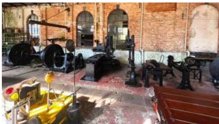
♦ Equipamentos após aplicação do óleo mineral. Fotos: Alexandre A. Pisciotano.
