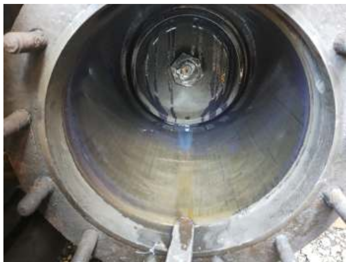
♦ Interior do cilindro da locomotiva 338, em ajustes. Foto HGF.
