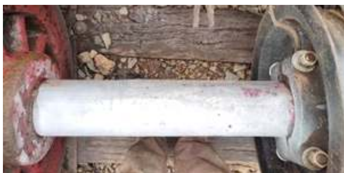
♦ Ensaio por líquido penetrante nas barras de carga, eixos e pontos considerados críticos.
