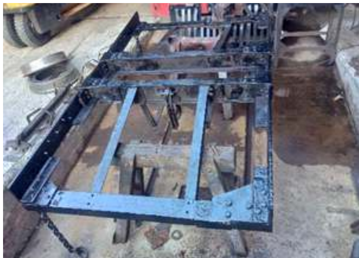
♦ Etapa de inspeção da armação dos trucks.
