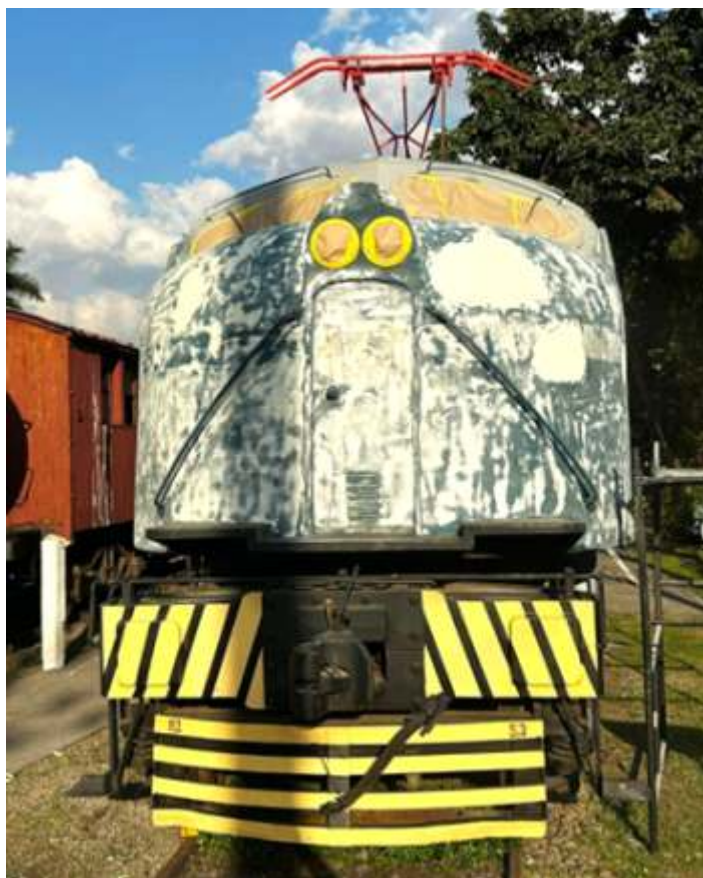
♦ Primeira aplicação de prime na #63871 e início do empapelamento das partes de vidro (janelas e faróis em ambos os lados).
