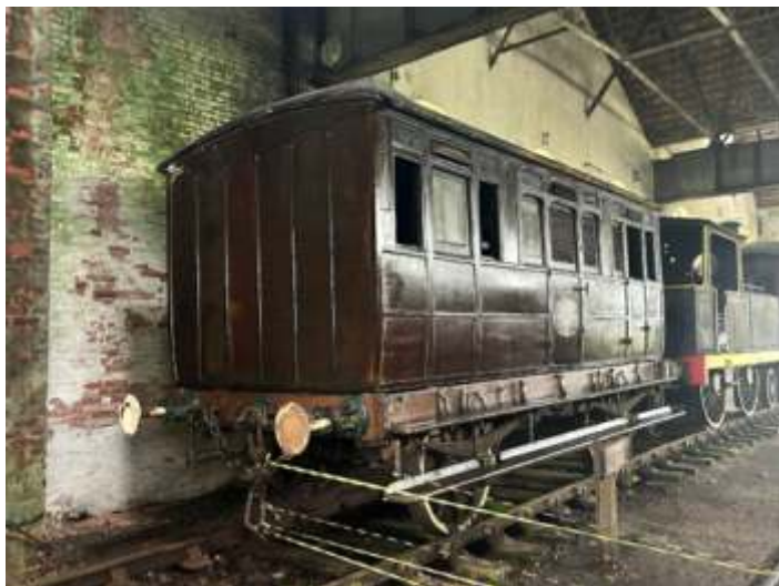
♦ O carro visto em outro ângulo após a aplicação do óleo USP. Foto: Alexandre A. Pisciotano.
