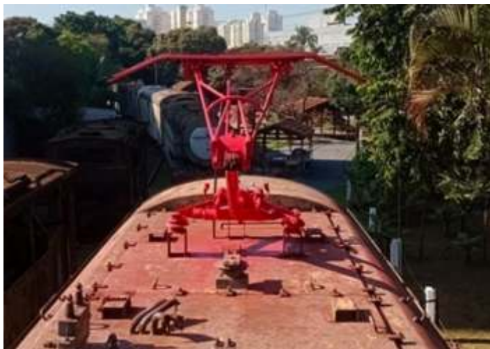
♦ Pantógrafo devidamente pintado de vermelho e teto com lixamento completo. Foto: RM Pinturas.
