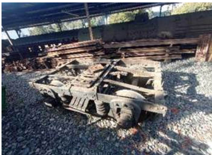
♦ Truque do carro PM-34 já removido, irá para o carro PD-47
