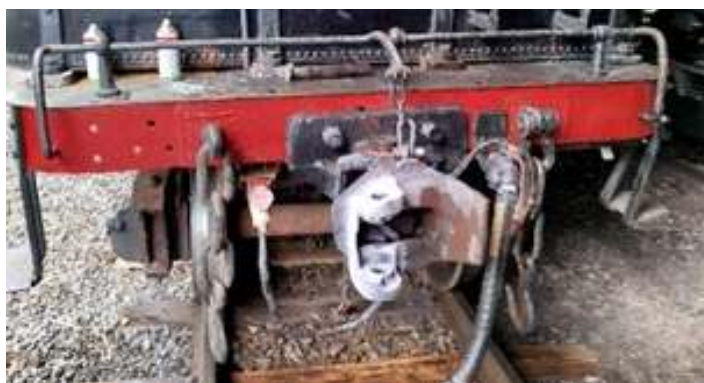
♦ Ensaio por líquido penetrante nos engates da locomotiva Ten-Wheel nº. 311.
