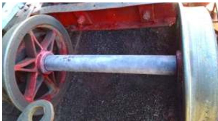
♦ Inspeção por líquido penetrante nos eixos dos truques do tender da locomotiva Mogul 11.
