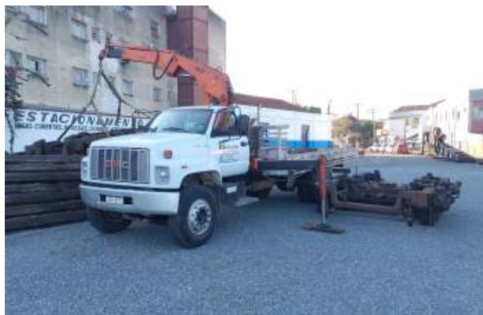
♦ Desmontagem de truques para remoção dos rodeiros.
