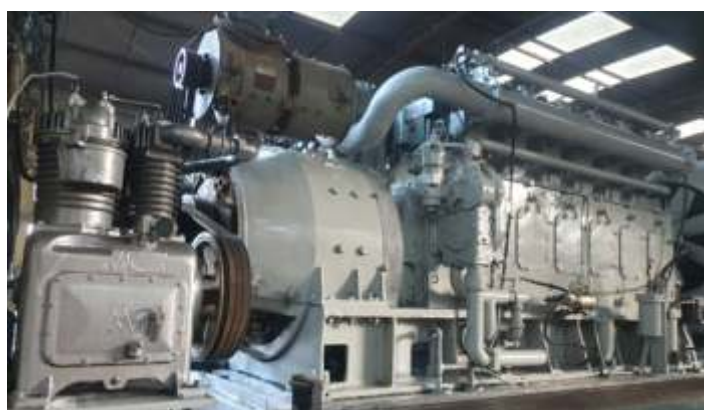
♦ Motor montado na 3128, sendo preparado para a partida.
