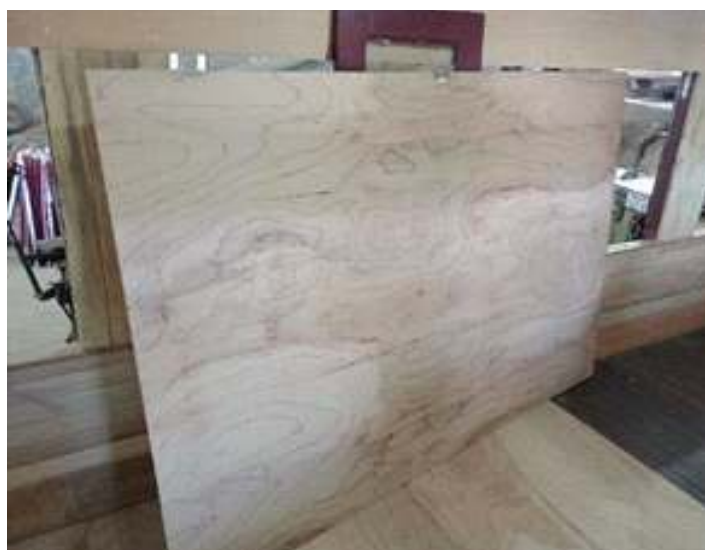
♦ Chapas de compensado à serem instaladas no assoalho do carro.
