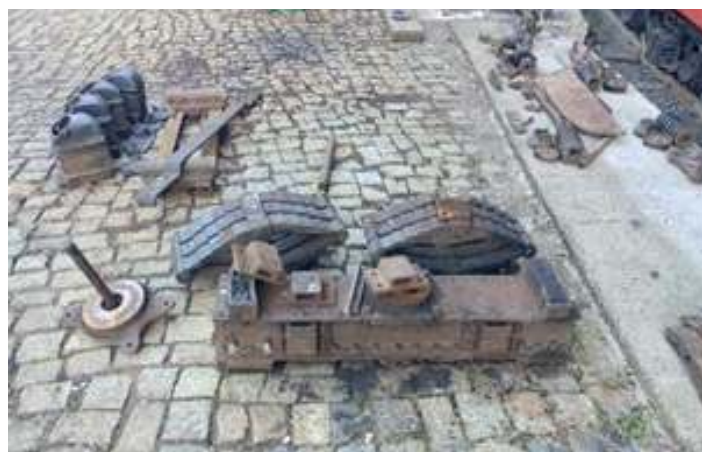
♦ Etapa de desmontagem completa dos componentes dos truques.
