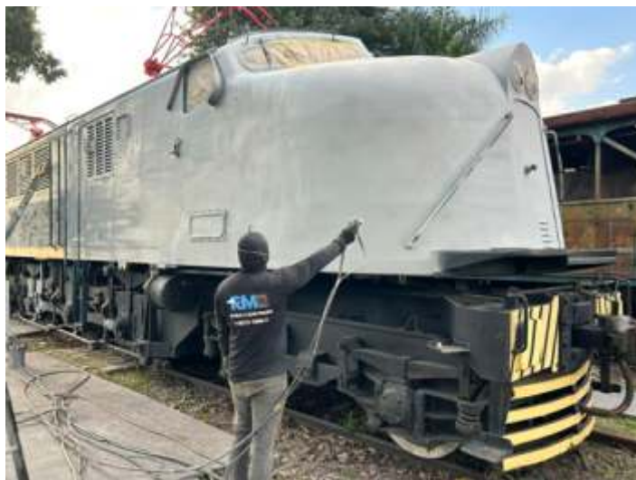
♦ Primeira aplicação de prime na #63871 e início do empapelamento das partes de vidro (janelas e faróis em ambos os lados).
