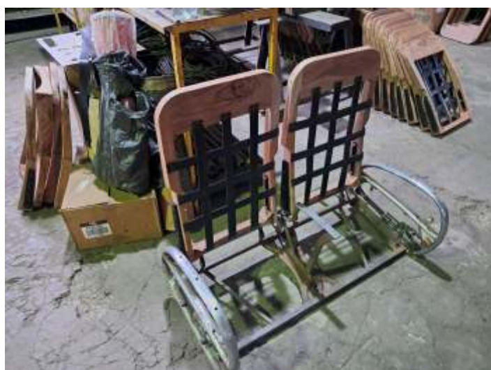
♦ Pré-montagem das estruturas de suporte do estofamento.
