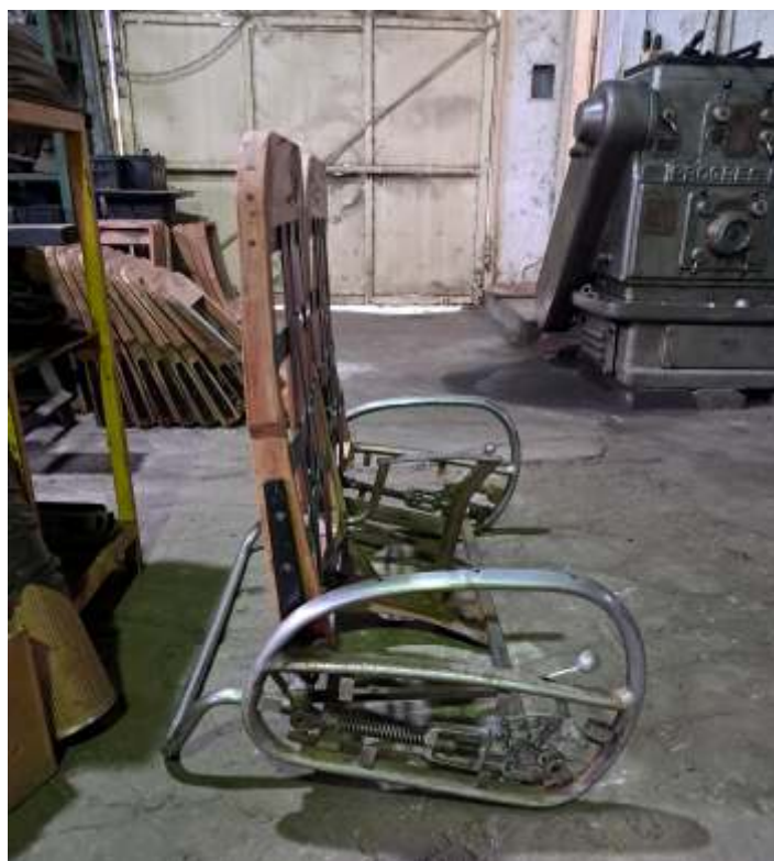
♦ As novas estruturas de madeira já com as novas faixas de apoio instaladas.
