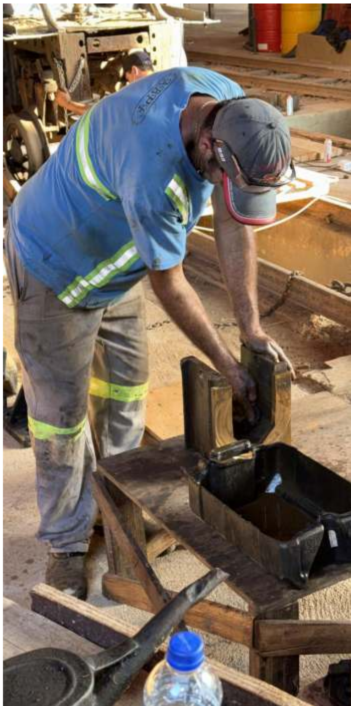
♦ Etapa de limpeza dos mancais, realizado por Ademir Muehlbauer.
