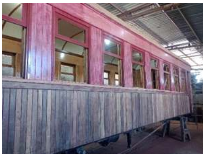
♦ Aspecto da lateral do carro PD-64 antes da etapa de pintura.
