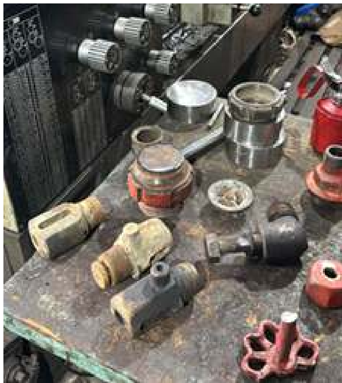
♦ Componentes em bronze já em Rio Negrinho, trazidos para retificação.
