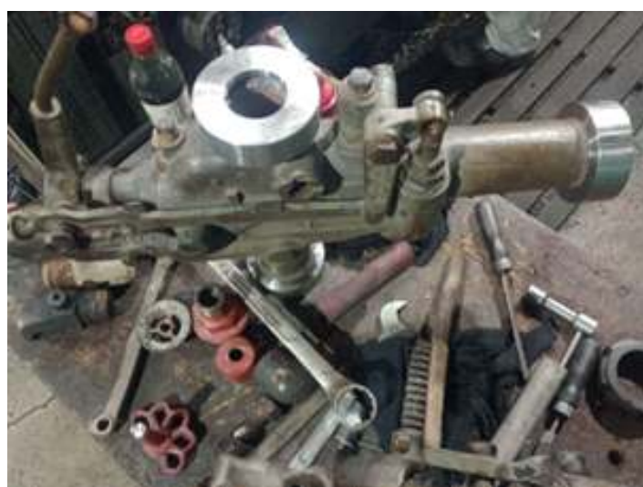
♦ Novas porcas da tubulação de injetores durante etapa de usinagem e montagem inicial.
