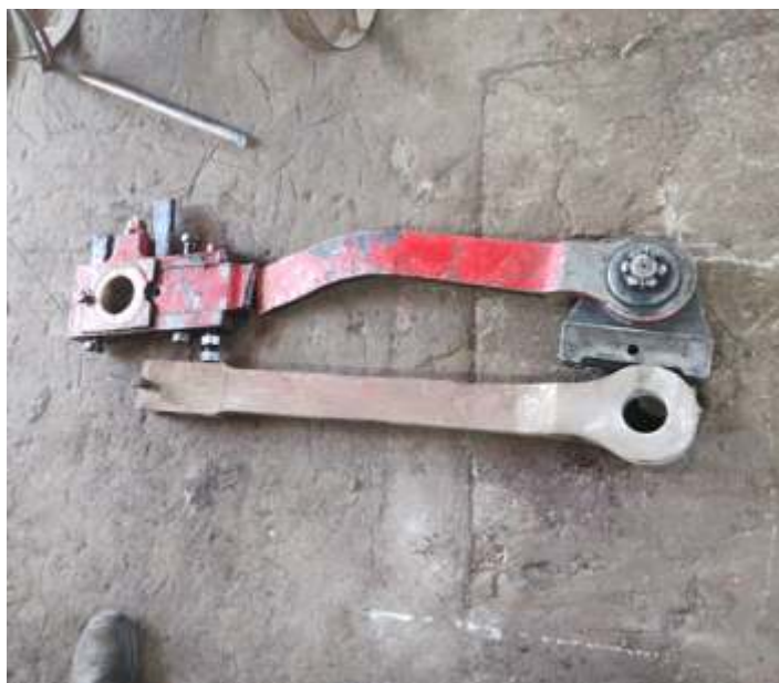
♦ Braçagem da 215 avariada e a outra a ser substituída. Foto HGF.
