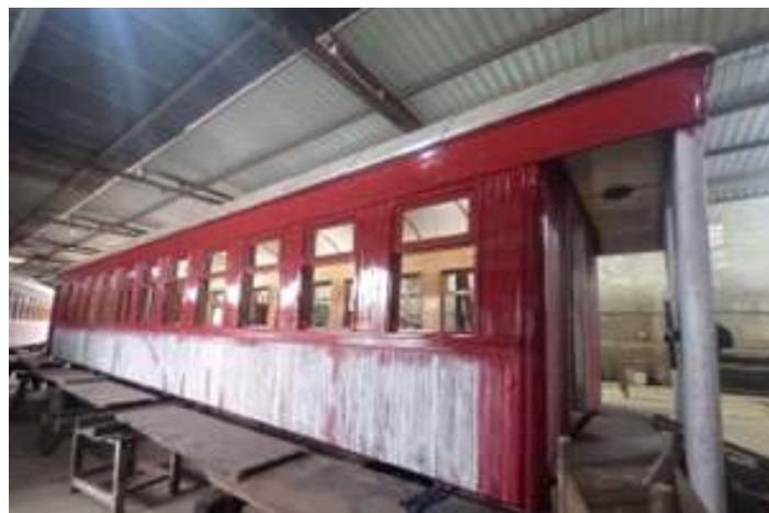
♦ Aspecto da lateral do carro PD-64 durante a etapa de pintura.
