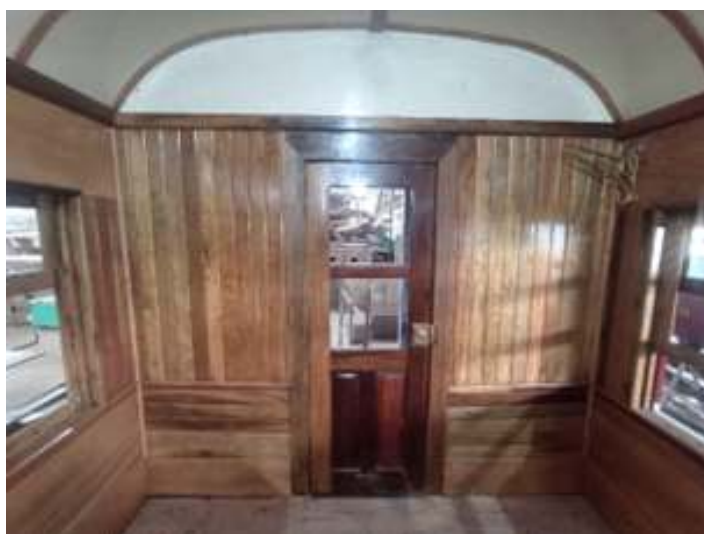
♦ Aspecto do interior das cabeceiras do carro PD-64 com o madeiramento interior finalizado e envernizado.p
