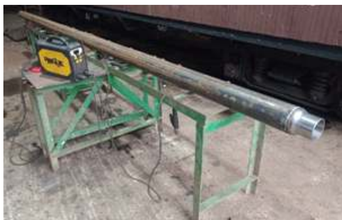
♦ Novas porcas da tubulação de injetores durante etapa de usinagem e montagem inicial.
