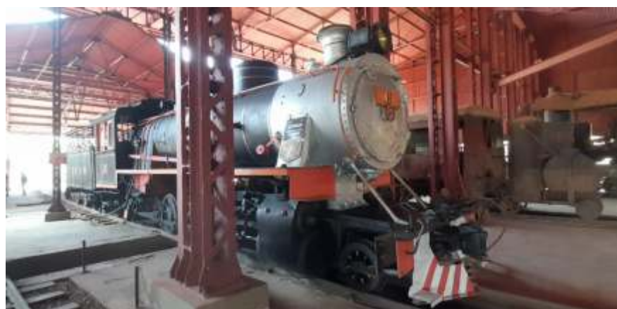
◆ Locomotiva Mikado 18 já posicionada na vala de manutenção.
