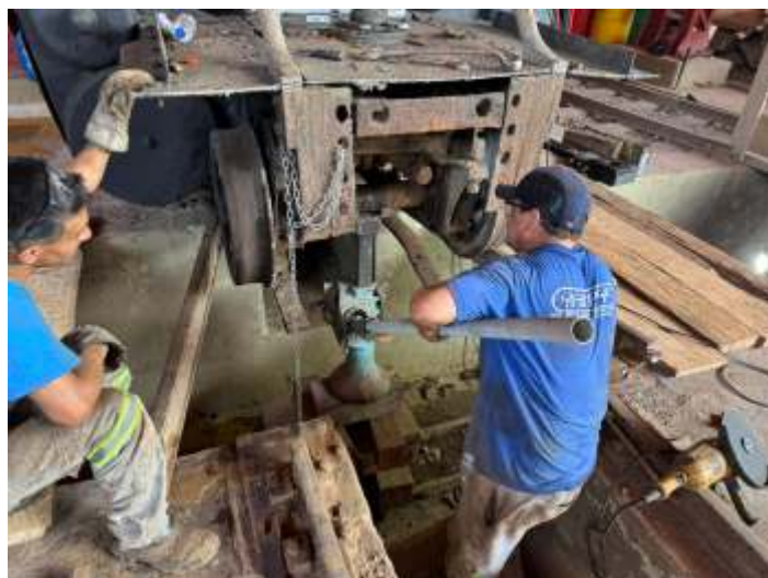
♦ Etapa de retirada da roda guia para limpeza de mancais.
