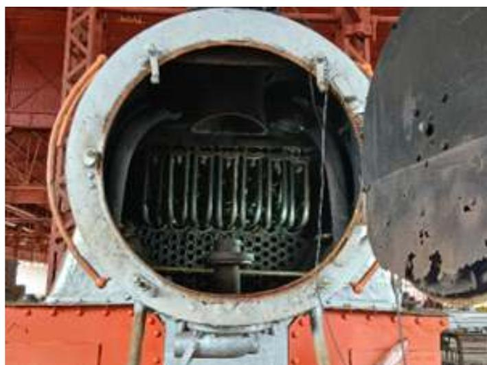
♦ Aspecto da caixa de fumaça da locomotiva com os tubos e serpentinas instalados.
