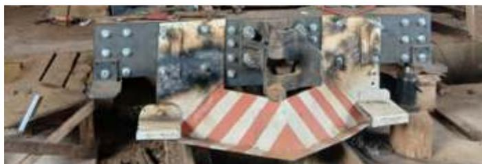
♦ Novo para-choque instalado juntamente com o limpatrielhos.
