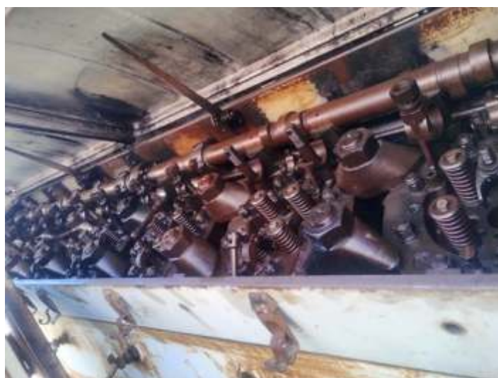
♦ Vista do cabeçote após limpeza e lubrificação, que em breve será todo desmontado. Foto HGF.
