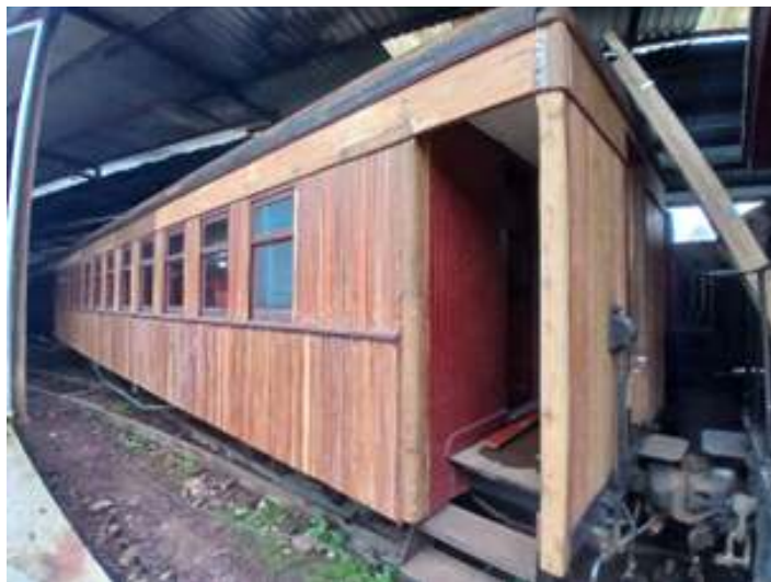
♦ Aspecto exterior completamente lixado ainda no mês anterior.
