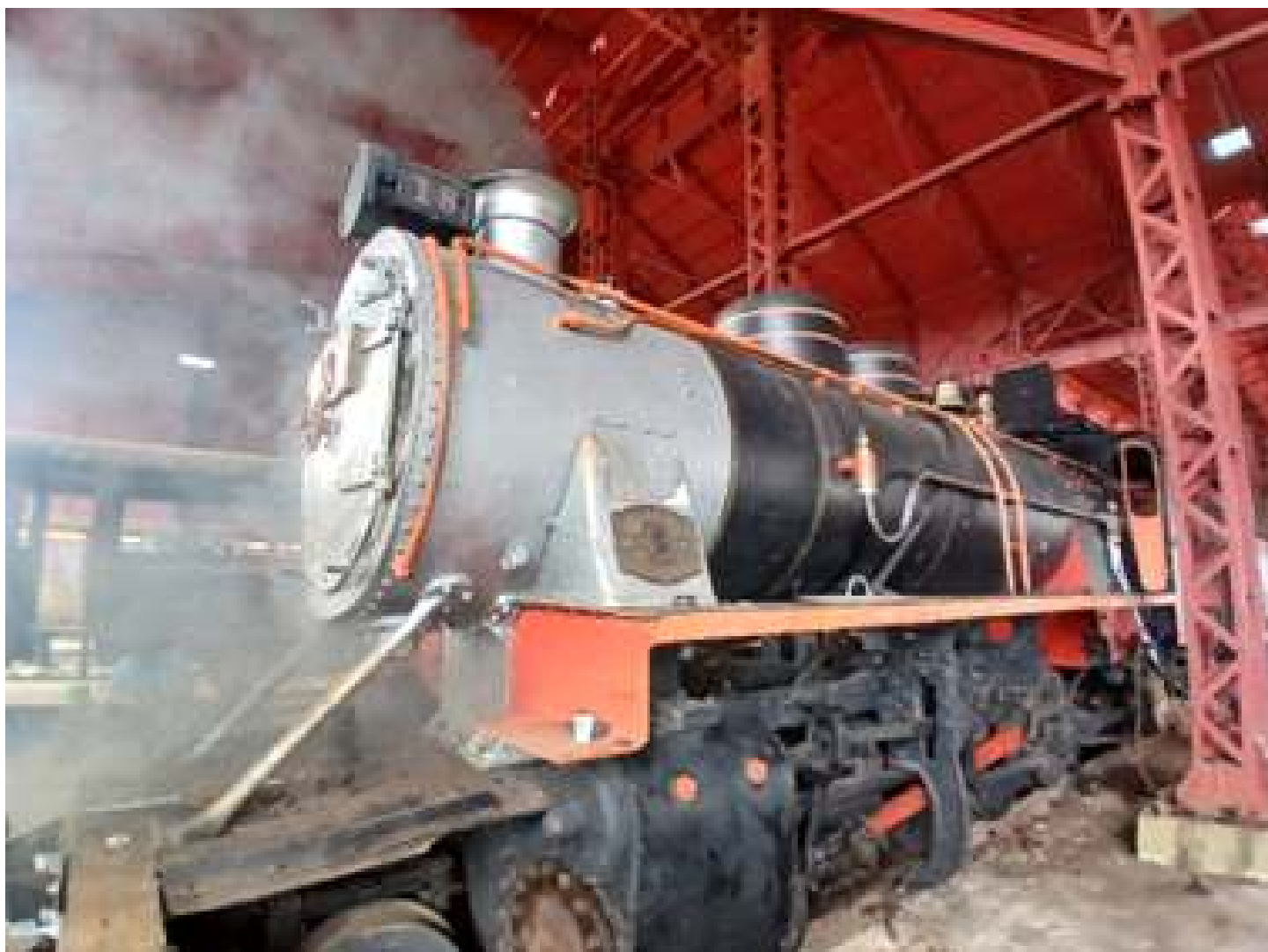
♦ A locomotiva Mikado #18 acesa no dia 01 de outubro, para aquecimento da caldeira da locomotiva, este foi o primeiro dia que a locomotiva pegou pressão, após 20 anos parada.
