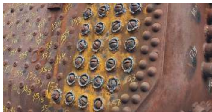
♦ Detalhe das cabeças dos estais flexíveis expostas.
