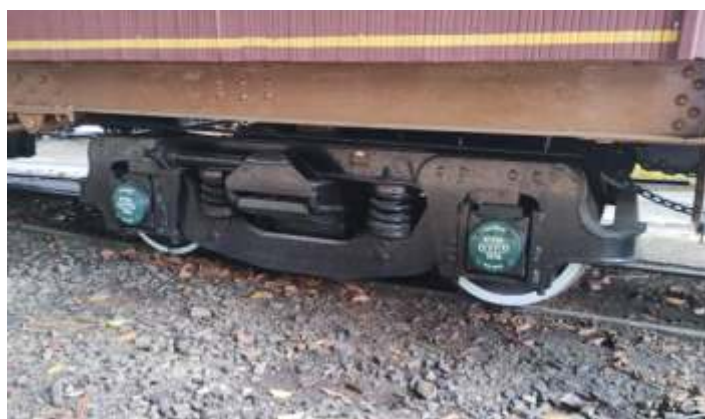
♦ Detalhe do truque instalado. Foto de HGF.
