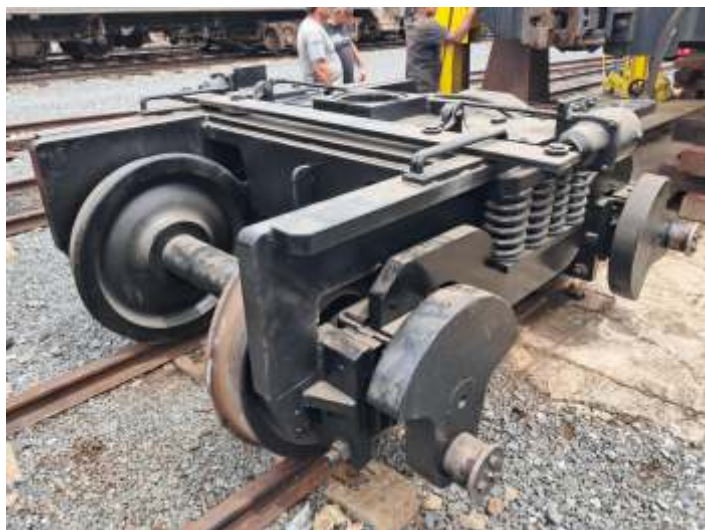
♦ Truque já posicionado na linha para instalação na GE 44T.
