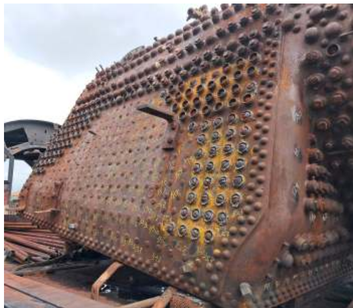
♦ Vários tampões e alguns suportes já removidos, expondo as cabeças dos estais flexíveis.
