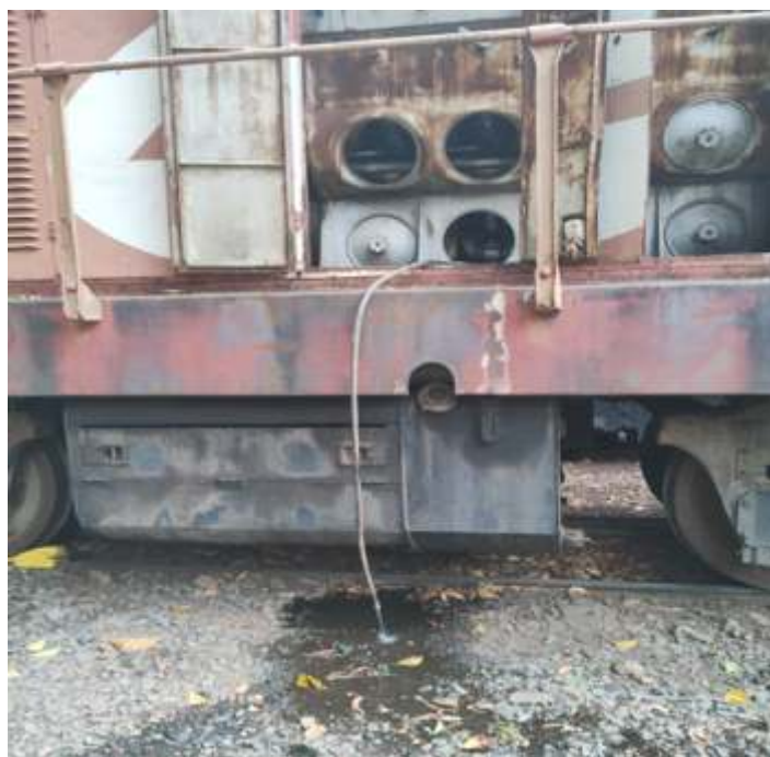
♦ Em todos esses anos encostada, com escape aberto, o motor estava cheio de água. Foto HGF, sendo drenada a água.
