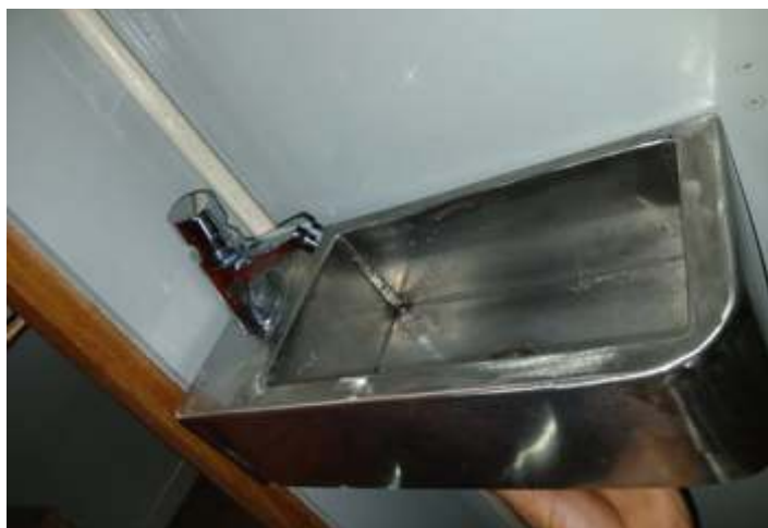
♦ Como o “banheiro” original do caboose é muito pequeno, pouco espaço ficou para a pia, e acabamos por construir uma em inox com dimensão adequada ao espaço existente. Foto de Robson Souza da Silva.
