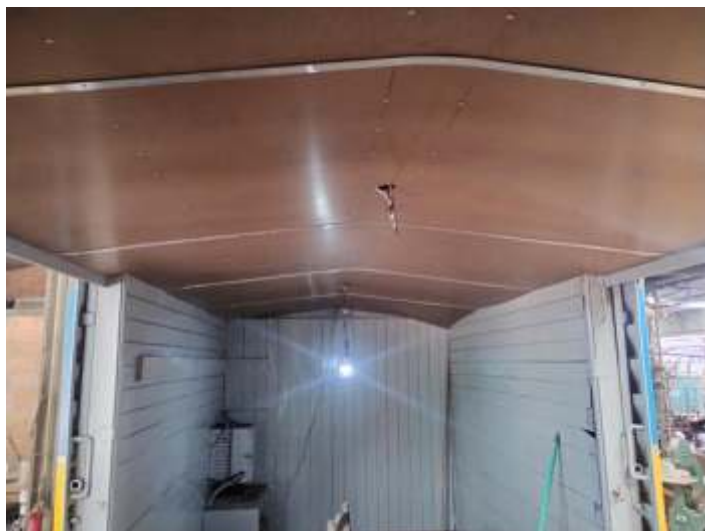
♦ Interior do salão do caboose recebendo o revestimento após a isolação feita com isopor. Foto HGF.
