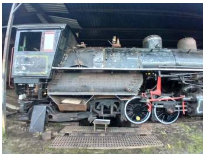
♦ Locomotiva Mallet #204 com a chaparia lixada para pintura. nota-se a ausência da terceira roda motriz retirada para pintura.
