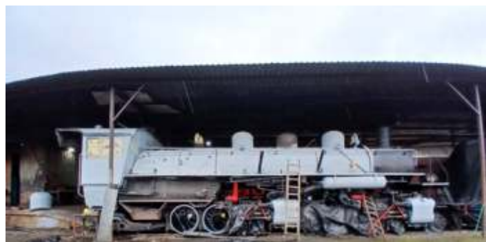
♦ Aspecto da locomotiva Mallet #204 ainda com tinta fundo.
