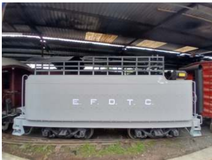
♦ Tender da locomotiva Mallet #204 com tinta fundo aplicada. aproveitou-se esta etapa para testar o tamanho e espaçamento das letras E.F.D.T.C.
