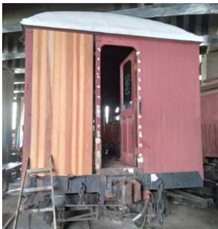
♦ A cabeceira já recebendo a primeira etapa de recuperação com novo madeiramento.
