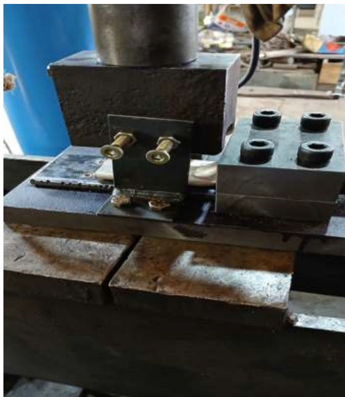
♦ Dispositivo para fazer terminal de cabo elétrico. Foto Leonel Martins.
