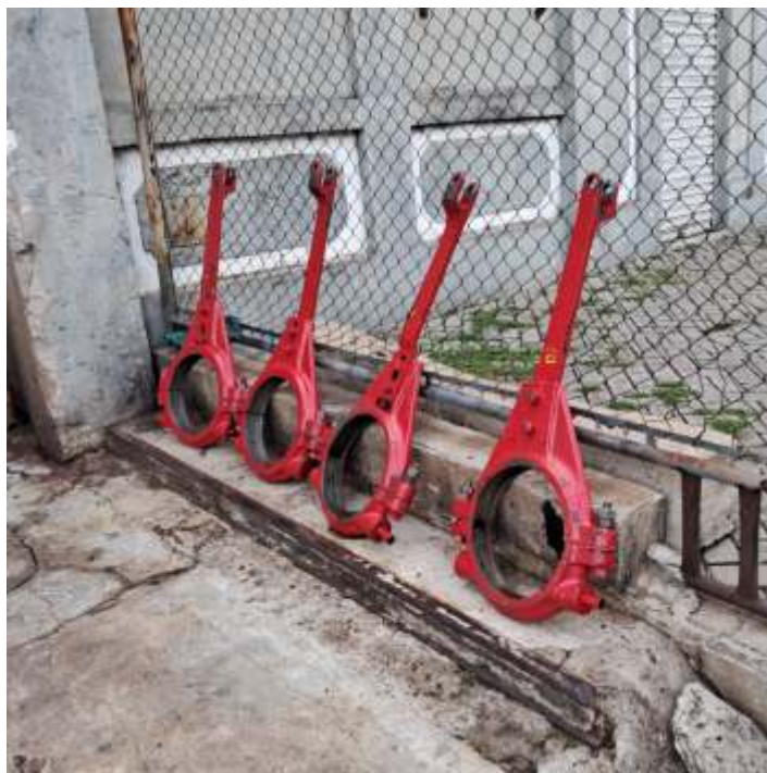
♦ Trabalhos nas braçagens da locomotiva nº 2.
