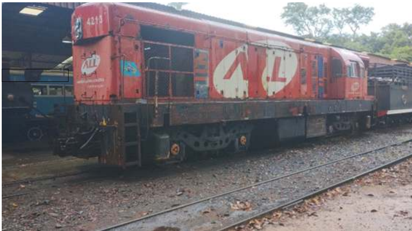
♦ Locomotiva G 12 números 4213 após alinhamento e instalação de portas faltantes e diversos outros reparos. Foto HGF.
