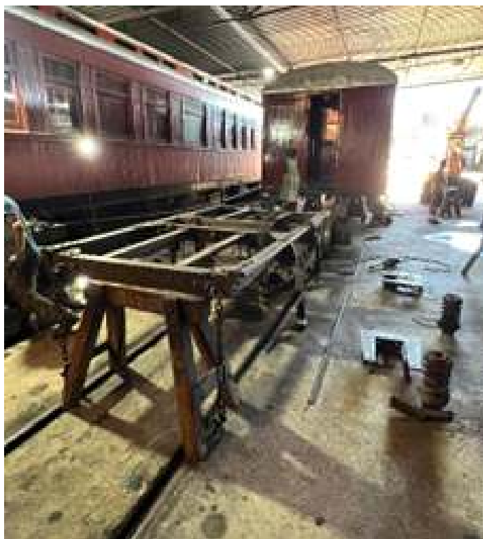
♦ Revisão dos truques do carro de passageiros PD-43.
