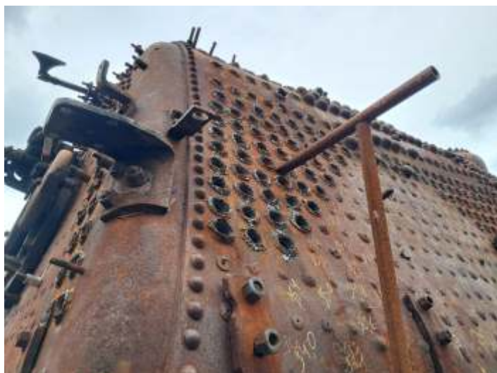
♦ Processo de remoção dos estais da caldeira da 353.
