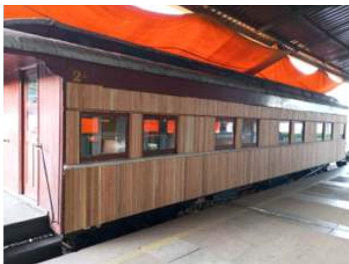
♦ Carro de passageiros SD-38 com madeiramento já trocado, faltando apenas pintura.
