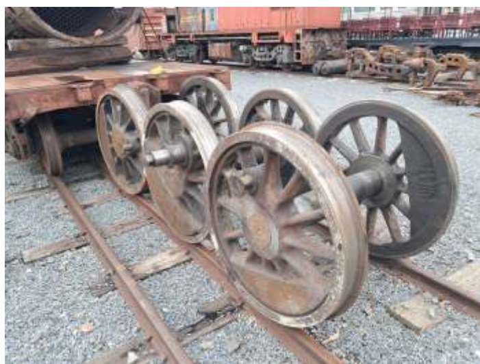
♦ Rodeiros da 332 sendo preparados para o transporte para as oficinas da ABPF em Rio Negrinho/SC.
