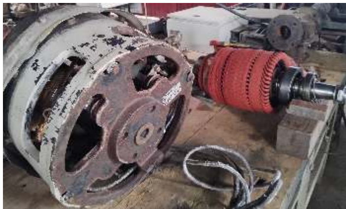
♦ Ventilador do freio dinâmico retirado para reparação.
