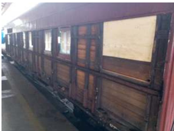
♦ Aspecto do carro de passageiros durante a remoção do madeiramento comprometido.
