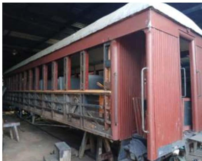
♦ Momento de remoção do madeiramento externo do carro de passageiros PM-34.
