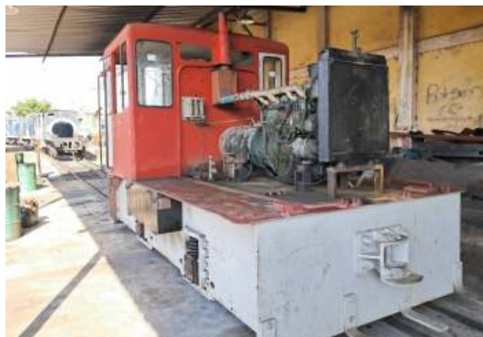
♦ A 502 já com o conjunto mecânico/elétrico montado aguardando a instalação do capô.
