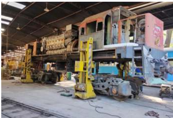
♦ Sendo erguida para retirada dos truques. Foto HGF.
