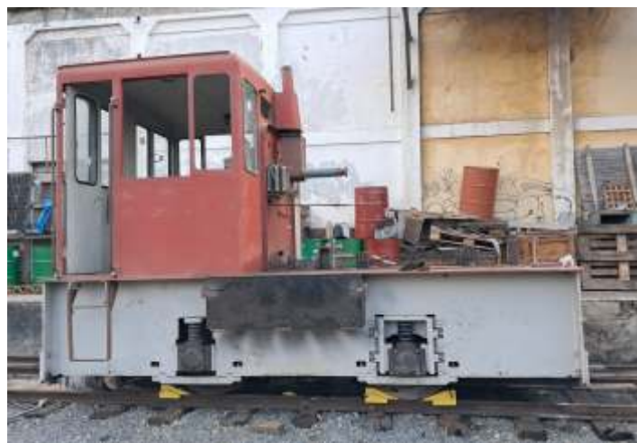
♦ Afim de se viabilizar a operação de colocação nos trilhos, o conjunto mecânico/elétrico foi removido para reduzir peso.
