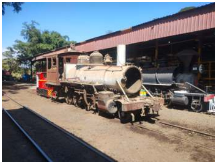
♦ Locomotiva 210 em testes após instalação das rodas. Foto HGF.
