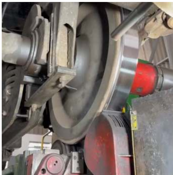
♦ Processo de reperfilamento das rodas do PI-3102.
