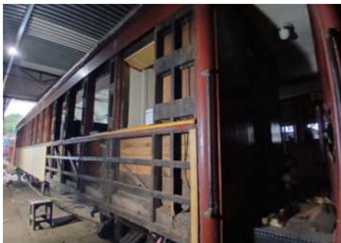
♦ Etapa de reposição de madeiramento externo, no carro de passageiros PM-34.
