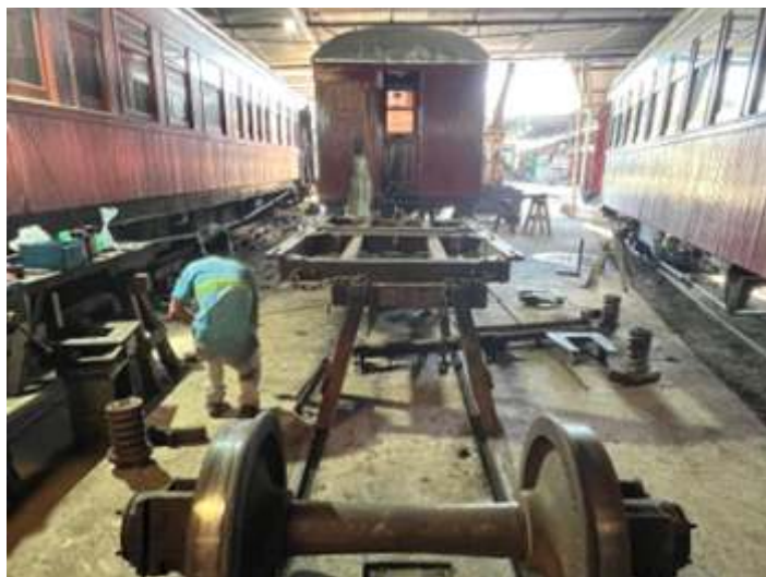
♦ Etapa de revisão e manutenção dos truques do carro de passageiros.
