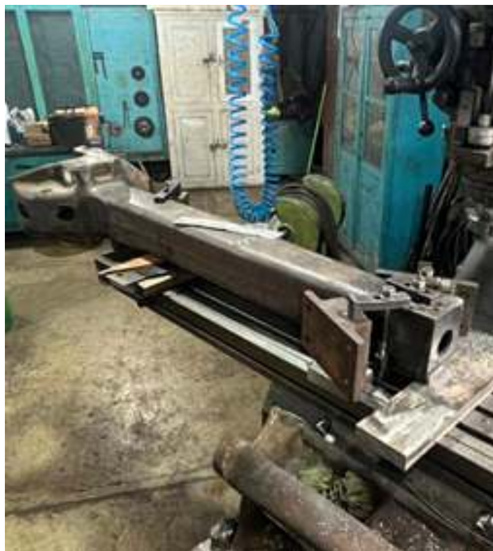
♦ Etapa de revisão e manutenção dos engates do carro de passageiro PM-34.
