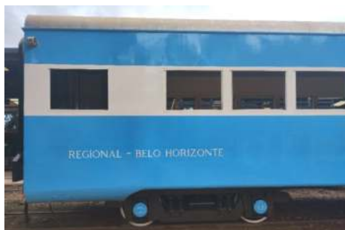
♦ Outra vista com os truques recolocados. Foto HGF.
