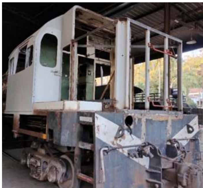
♦ Locomotiva recebendo estrutura toda nova. Foto HGF.
