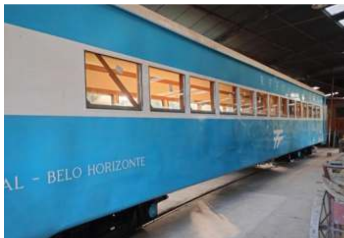
♦ Vista lateral com as novas janelas instaladas. Foto HGF.
