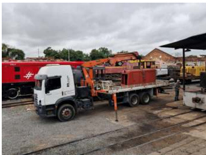
♦ Processo de remoção do capô da locomotiva GE15Ton.
