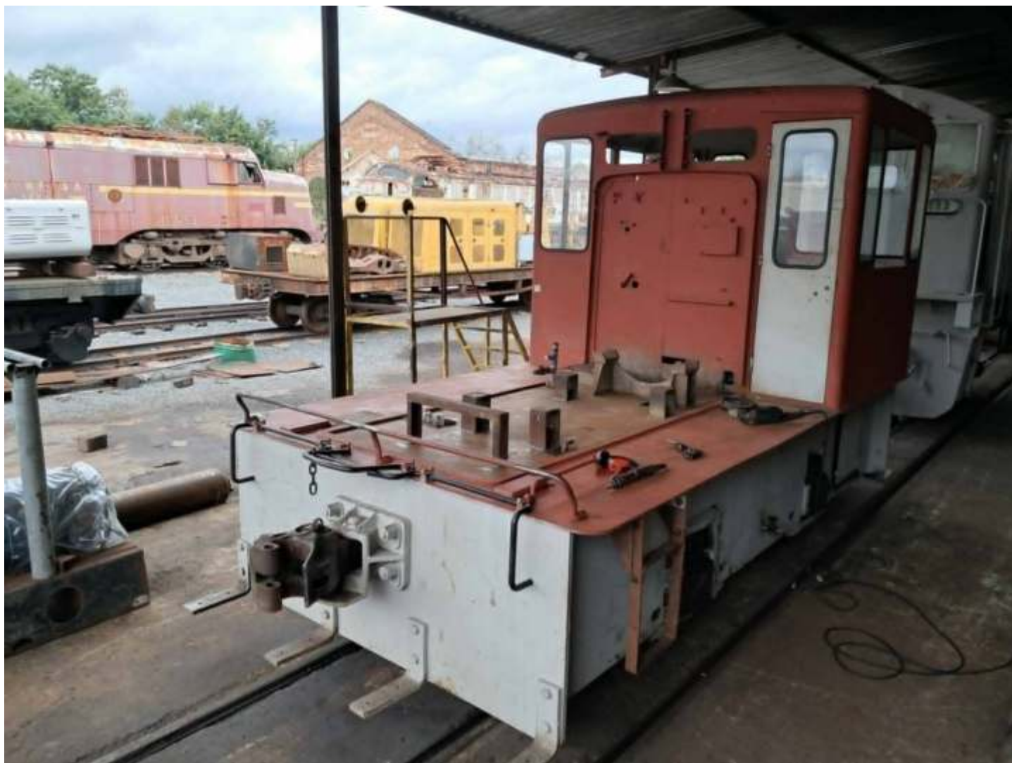
♦ Prosseguem os trabalhos na “Dondoca” 502: foi preciso remover novamente o capô para a realização de ajustes.
