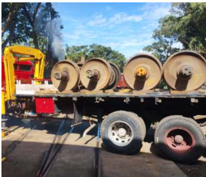
♦ Carregamento dos rodeiros para reforma. Foto HGF.
