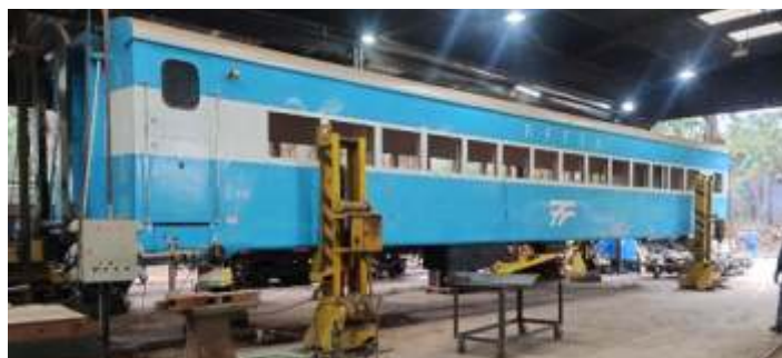
♦ Carro erguido para manutenção de truques. Foto HGF.
