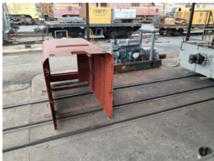
♦ O capô e o conjunto motor diesel-gerador já fora da loc.
