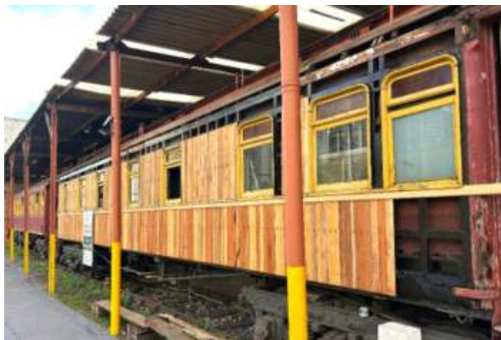
♦ A lateral quase concluída com o novo madeiramento vindo da nossa marcenaria da RSM em São Lourenço/MG.
