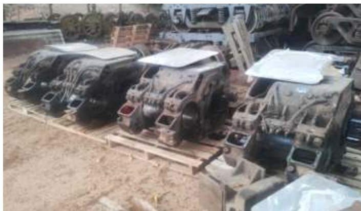
♦ Motores de tração D 29 da locomotiva G 12 que estão em reforma. Foto HGF.
