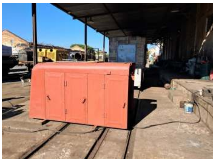
♦ O capô foi removido para o processo de pintura interno.
