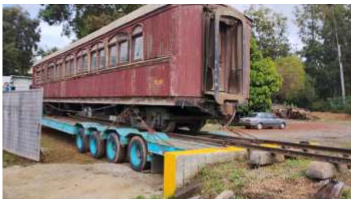
♦ Carreta posicionada no embarcador de Anhumas para descarga do carro NOB. Foto HGF.
