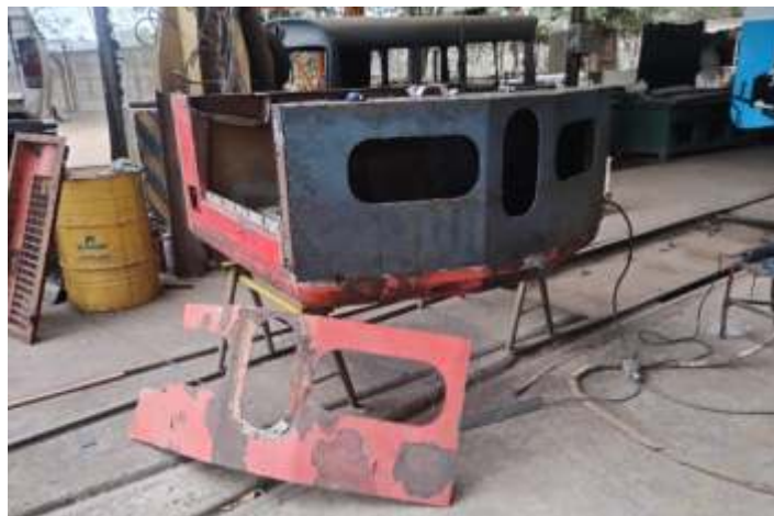
♦ Reforma da caldeiraria da G 12. Foto HGF.
