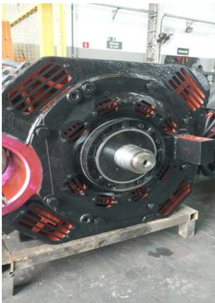
♦ Motor de tração da G 12 em recuperação. Foto ZW.
