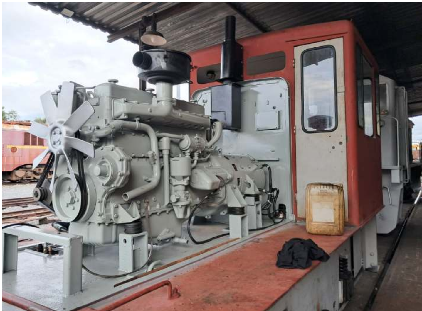
♦ Prosseguem os trabalhos na 502: conjunto motor/gerador já reinstalados após ajustes e aplicação de nova pintura.
