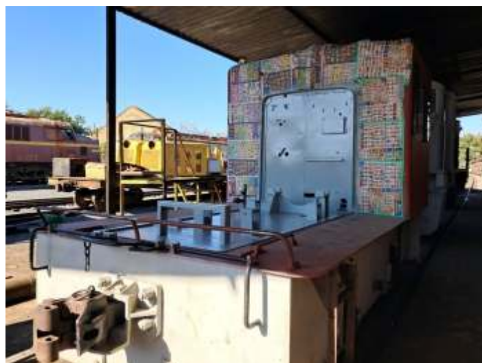
♦ Nova pintura já aplicada no berço do motor.
