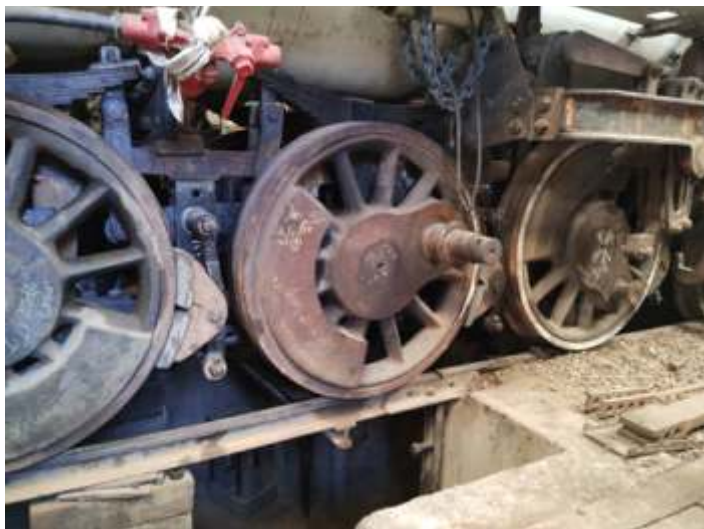
♦ Locomotiva 210 já com os freios montados. Foto HGF.
