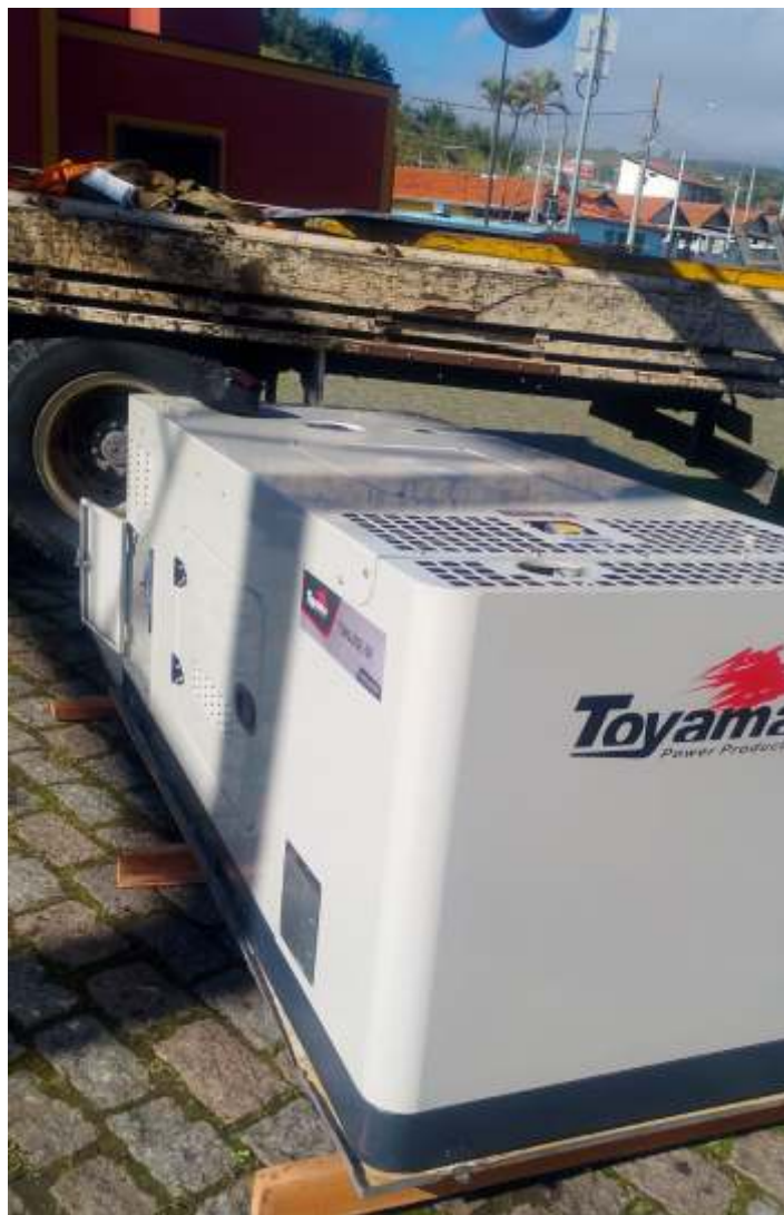
♦ O novo gerador sendo descarregado em Guararema para ser instalado sob o carro restaurante.
