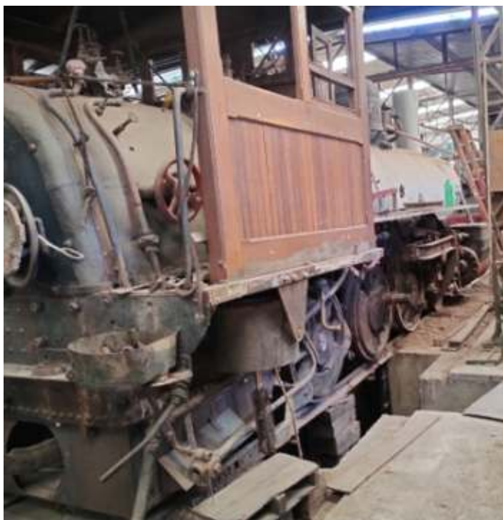
♦ Detalhe da panela de freio a vácuo já instalada. Foto HGF.
