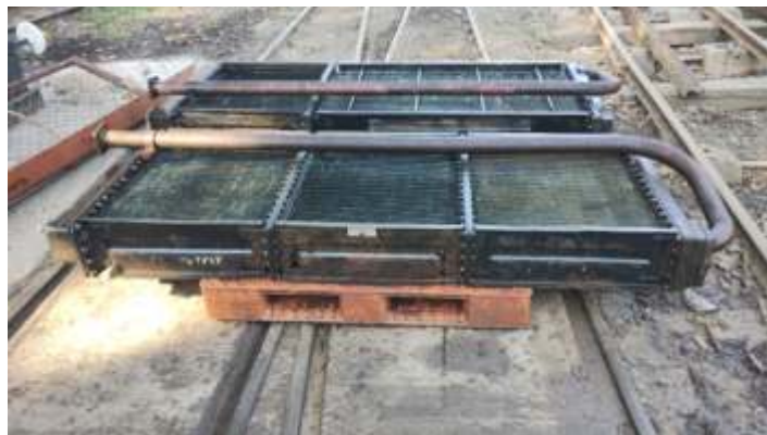
♦ Estado em que estavam os radiadores da G 12. Foto HGF.
