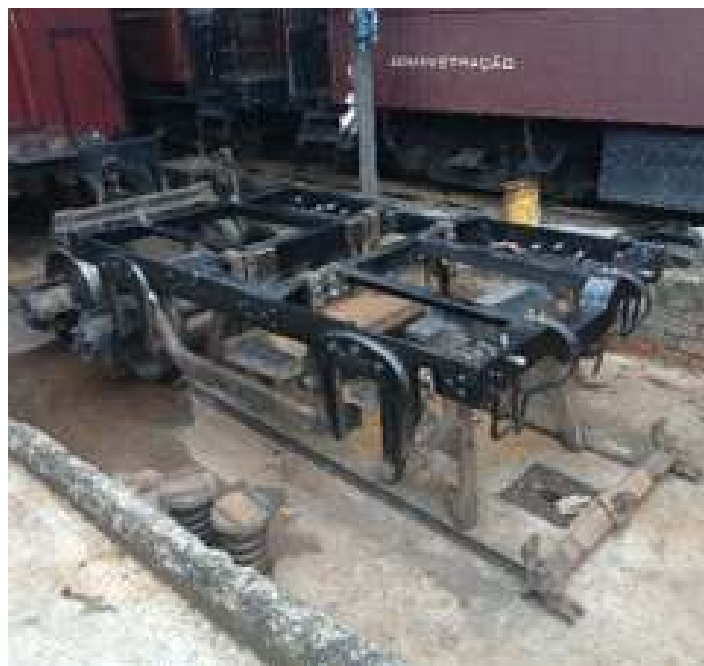
♦ Manutenção nos truques do carro de passageiros PD-46.
