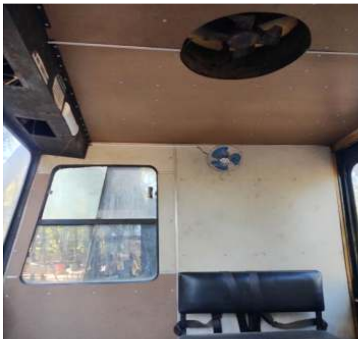
♦ Interior da cabina com novos forros. Foto HGF.
