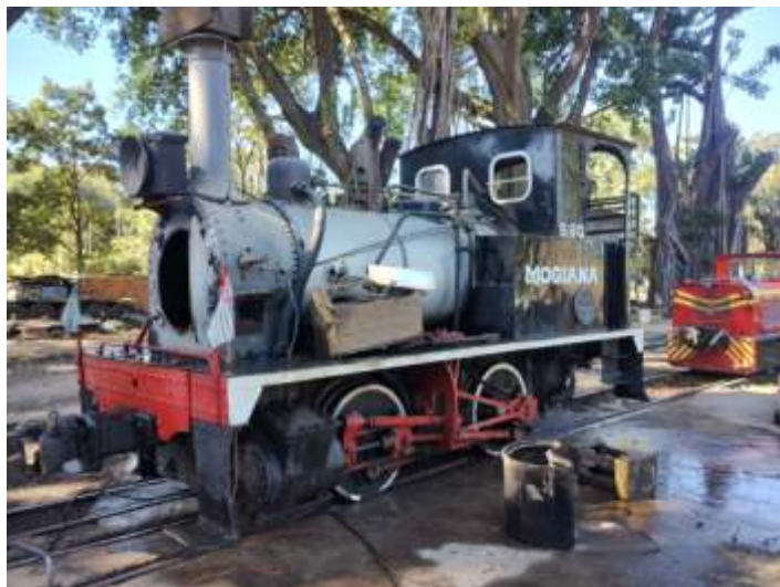
♦ Locomotiva 980 em processo de lavagem após retirada dos tubos da caldeira. Foto HGF.
