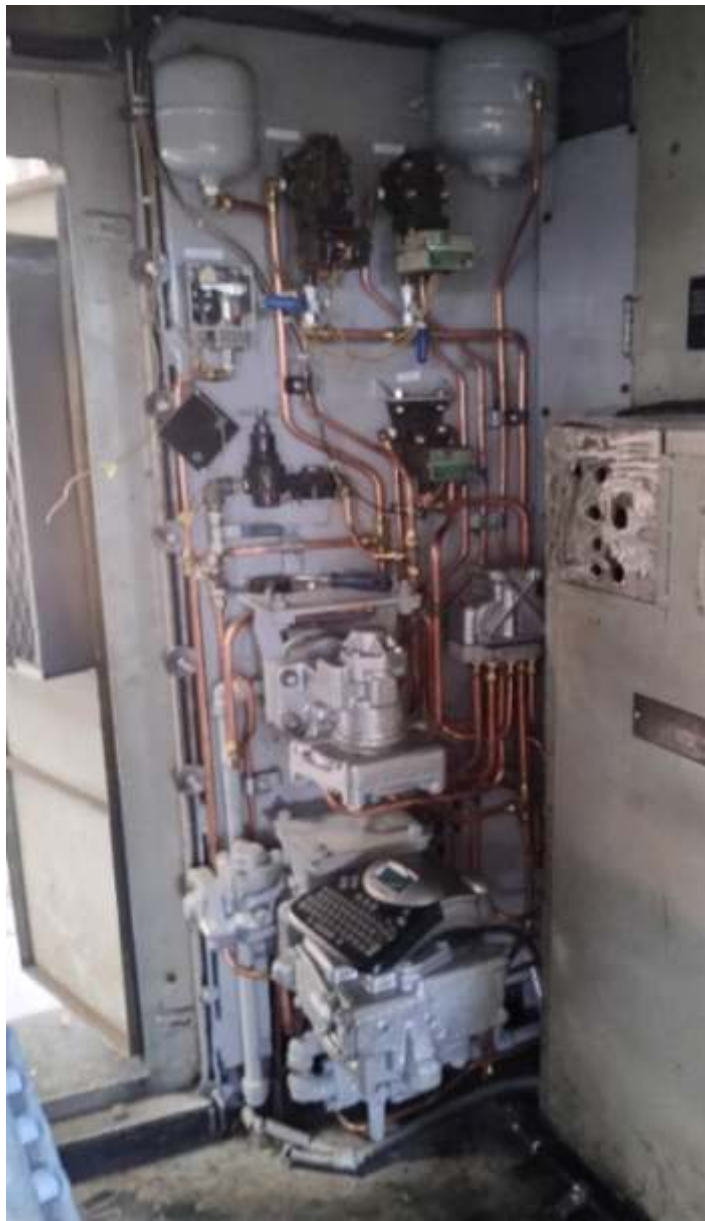
♦ Novo sistema de freios da GL-8 número 57. Foto HGF.
