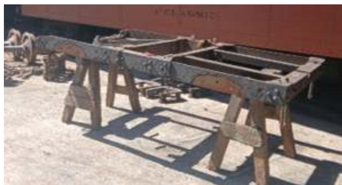
♦ Manutenção nos truques do carro de passageiros PD-47.
