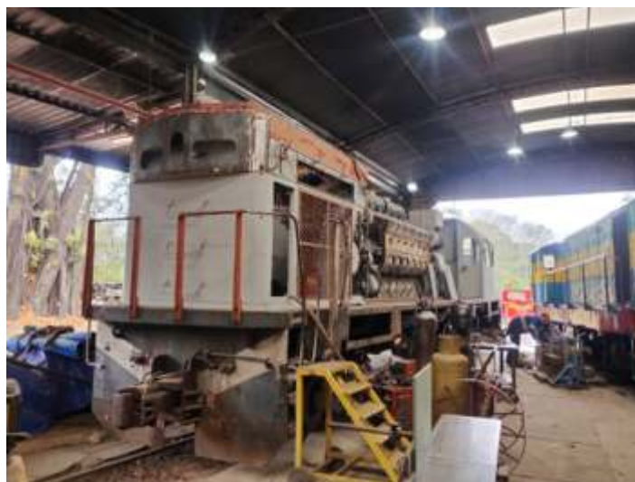
♦ G 12 na caldeiraria com ajuste do compartimento dos radiadores. Foto HGF.
