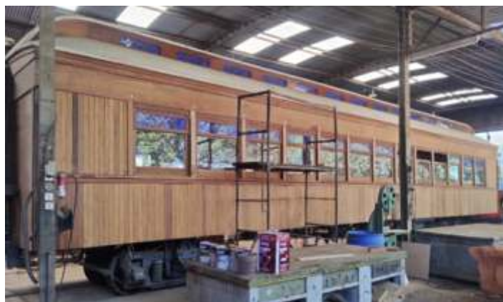
♦ Carro restaurante R-1 da Mogiana, sendo reenvernizado.
