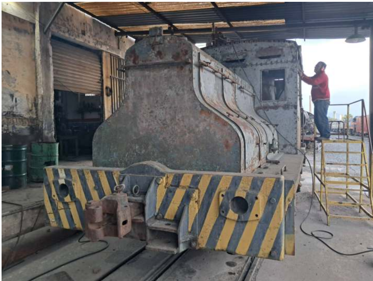
♦ Trabalhos de funilaria na locomotiva Sentinel sendo realizados nas oficinas da ABPF em Cruzeiro/SP.
