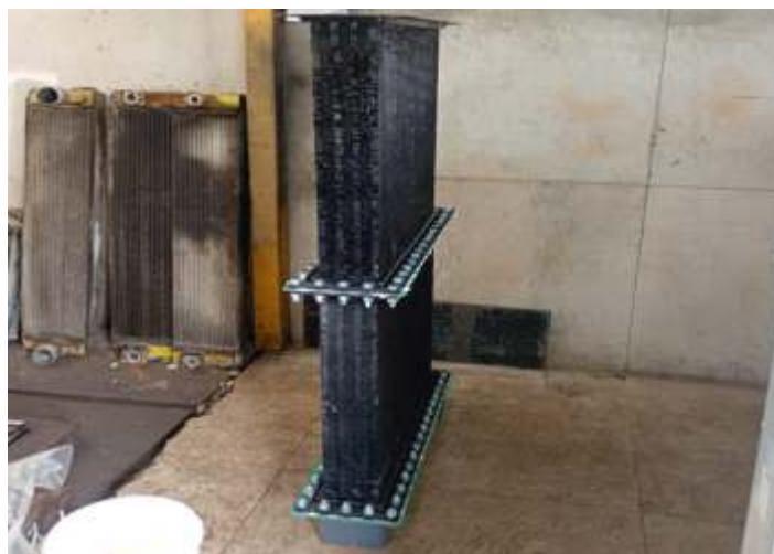
♦ Radiador da G 12 sendo remontado. Foto Luiz Leite - RC Radiadores.
