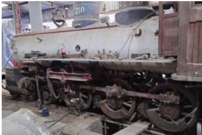
♦ As braçagens da articulação instaladas. Foto HGF.
