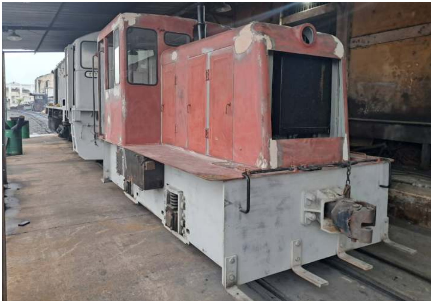
♦ Prosseguem os trabalhos de funilaria e montagem de acabamentos na pequena GE15Ton.
